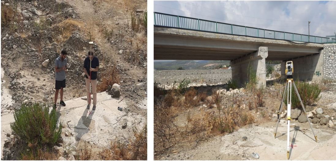
Şekil 3.9 Köprü yapısı için arazi çalışması sırasında YKN ve KN ölçülmesi.
