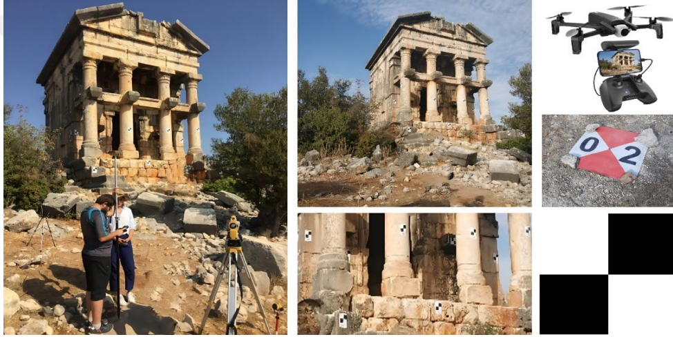
Şekil 3.11 GNSS alıcısı ve Total-station ile hedeflerin ölçülmesi ve saha çalışması.
