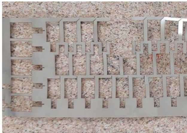
Şekil 3.6. Lazer kesimi sonrasında, paslanmaz çelik elektrotların demonte edilmiş hali (bu şekil, paslanmaz çelik elektrotların yapısını göstermek için kullanılmıştır).
