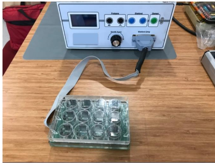
Şekil 4.6. Elektro-kültür plakanın, standart bir 12-kuyucuklu plakaya uygulanması sonrası elektrik alan kaynağına DB25 konnektörü ile bağlantısı.
