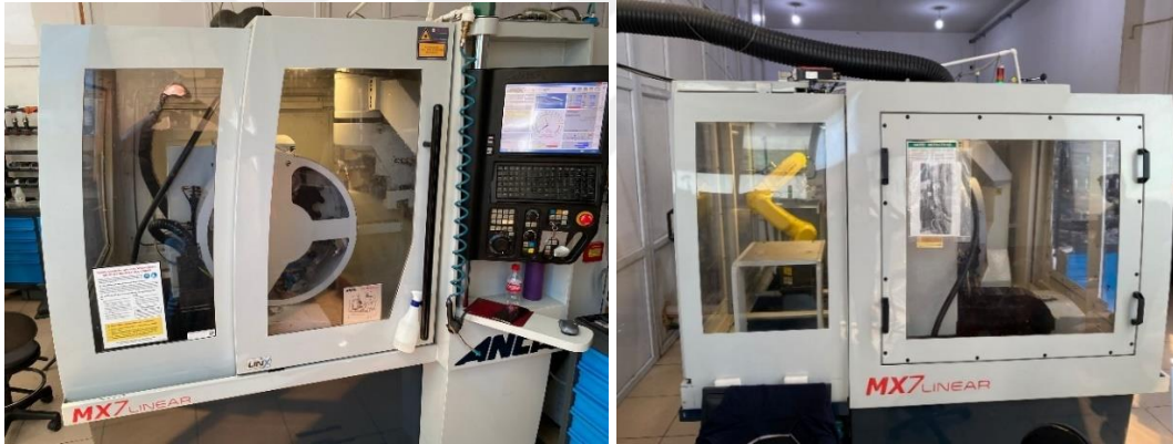
Şekil 3.1 Deneylerde kullanılan takımların işlendiği tezgah ANCA MX7 LINEAR
