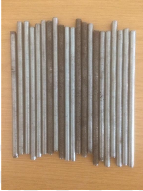
Şekil 3.12 Sıyırma testleri için kullanılan 165mm uzunluğundaki M8 gijonlar
