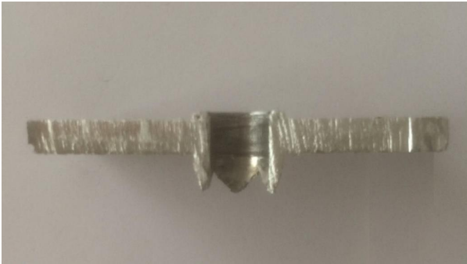
Şekil 3.16 Mikro sertlik ölçümleri için tam ortadan ikiye kesilmiş dişsiz numune
