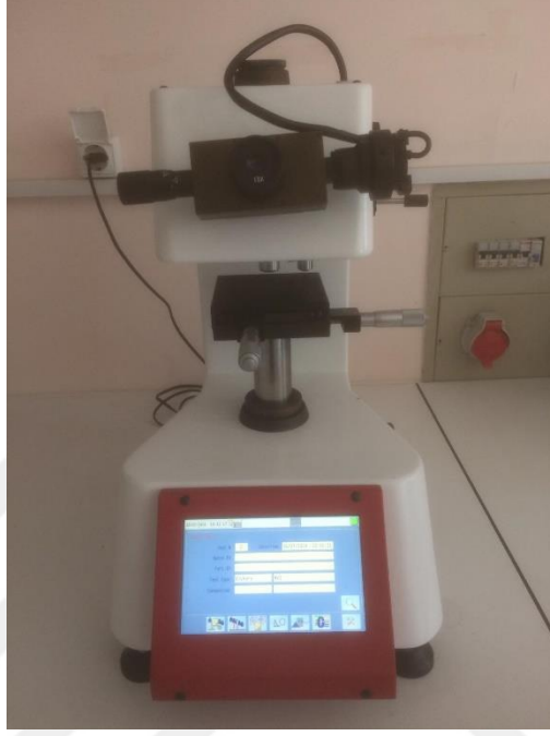
Şekil 3.14 Galileo Durometria marka, Vickers HV1 OD mikro sertlik ölçüm cihazı
