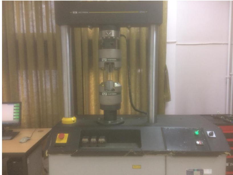
Şekil 3.11 Çekme testinde kullanılan INSTRON 8516 cihazı
