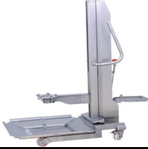
Döner Kebap Taşıma Aparatı: Hazırlanan çiğ döner kebapı streç vb. ürünlerle sarılmasına yardımcı olan ve çiğ döner kebapı döner makinesine taşınmasını ve yerleştirilmesine yardımcı olan bir ekipmandır.
