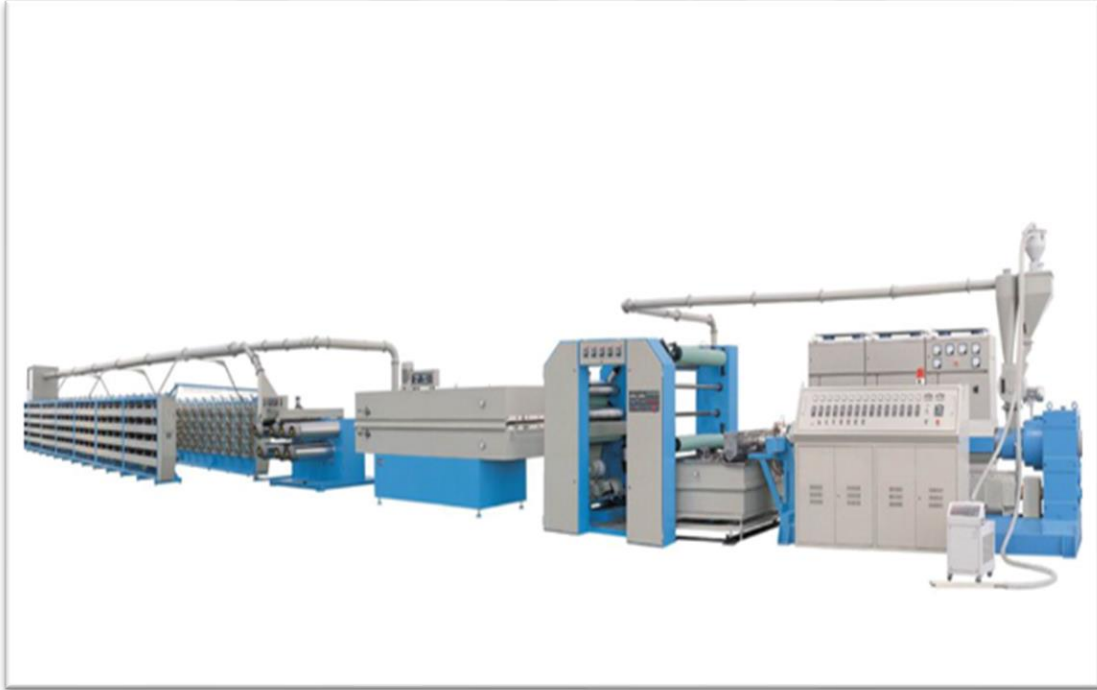
Şekil 4. 3. PP şerit iplik üretimi ekstrüzyon hattı (URL-2)
