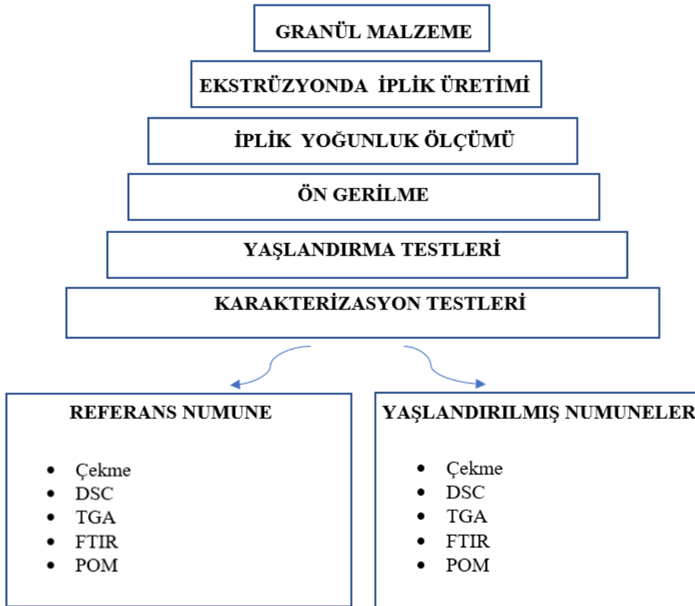
Şekil 4.1. Çalışmanın akış şeması ve deney metodolojisi
