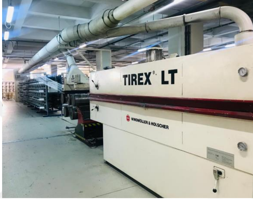
Şekil 4.2. Numune üretiminde kullanılan ekstrüzyon makinesi
