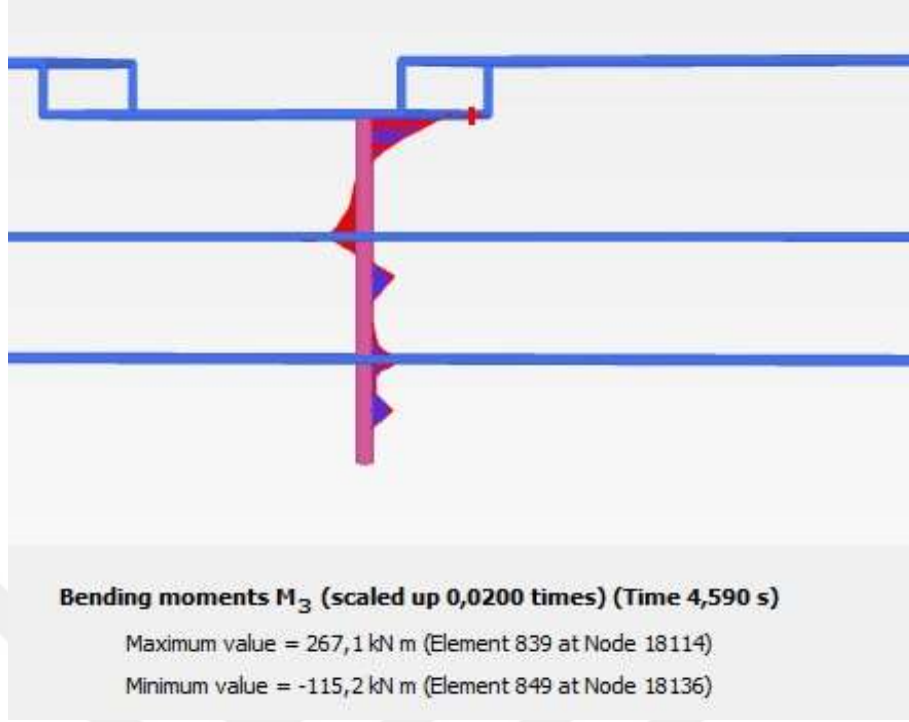
Şekil 4.4. Ø80 fore kazık için t=4,5 saniyede eylemsizlik etkileşiminin moment değeri ( M_3 )
