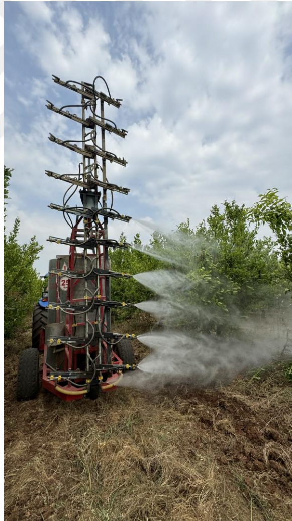
Şekil 3.5. Düşey Çubuklu Salınım Hareketli Pülverizatör ve düşeyde ilaç dağılımının fiziksel görünümü
