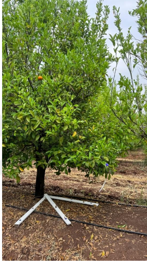
Şekil 3.12. Zemindeki ilaç kayıplarının belirlenmesi için suya duyarlı kağıtların yerleşimi
