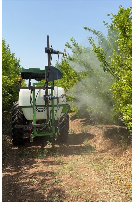
Şekil 3.4. Hidrolik Döner Başlıklı Pülverizatörün düşeyde ilaç dağılımının fiziksel görüntüsü
