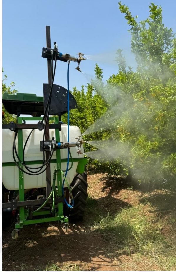
Şekil 3.3. Hidrolik Döner Başlıklı Pülverizatörün bahçede çalıştırılması
