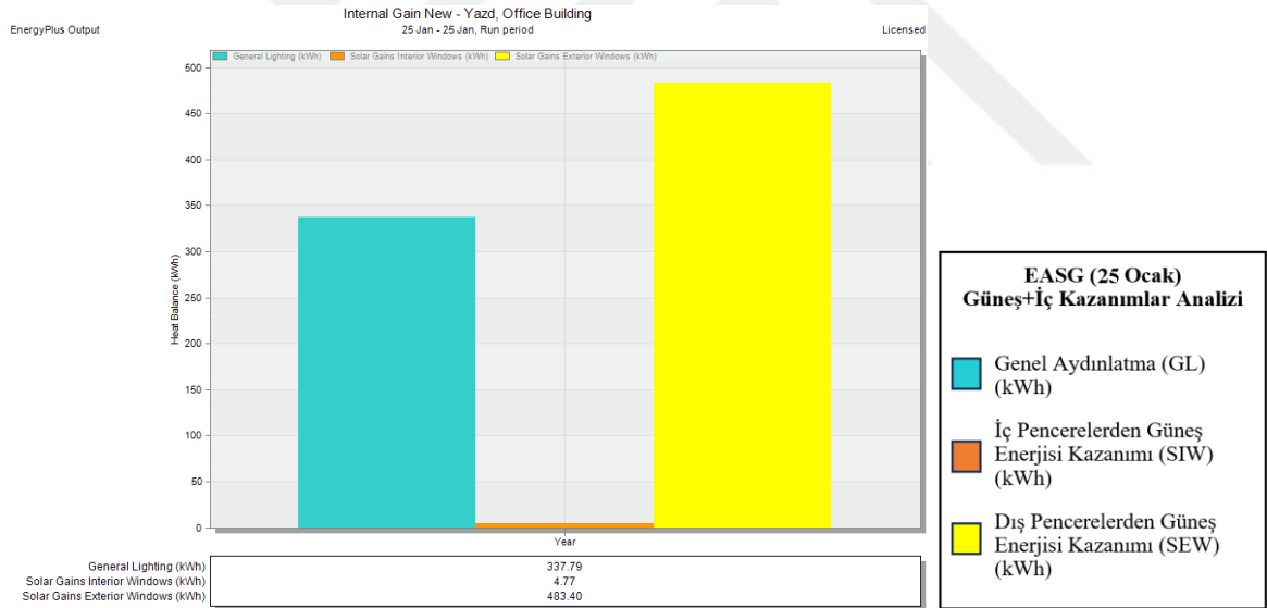
Şekil 4.30: KONF-3'te elde edilen EASG (25 Ocak) iç kazanımlar değerleri (Yazar tarafından Design Builder yazılımında üretilmiştir.)
