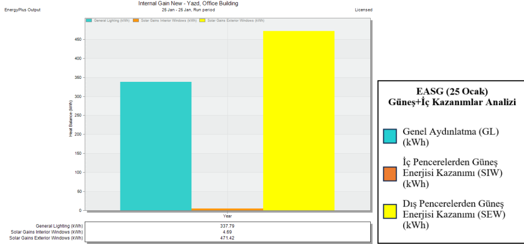
Şekil 4.10: KONF-1’de elde edilen EASG (25 Ocak) iç kazanımlar değerleri (Yazar tarafından Design Builder yazılımında üretilmiştir.)
