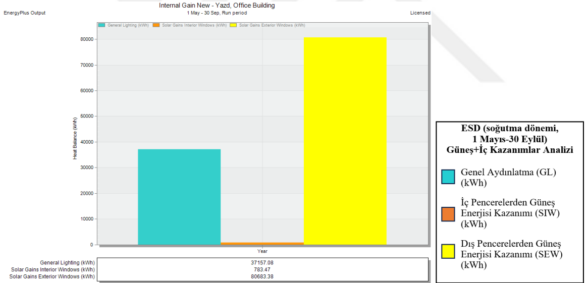
Şekil 4.27: KONF-3'te elde edilen ESD (soğutma dönemi, 1 Mayıs-30 Eylül) iç kazanımlar değerleri (Yazar tarafından Design Builder yazılımında üretilmiştir.)
