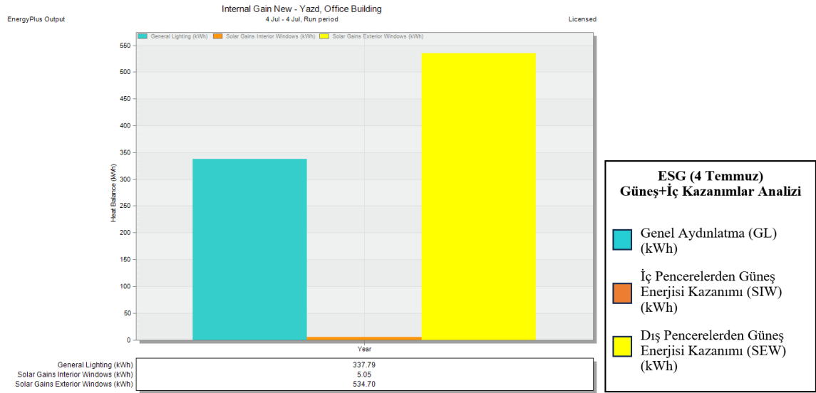
Şekil 4.39: KONF-4'te elde edilen ESG (4 Temmuz) iç kazanımlar değerleri (Yazar tarafından Design Builder yazılımında üretilmiştir.)
