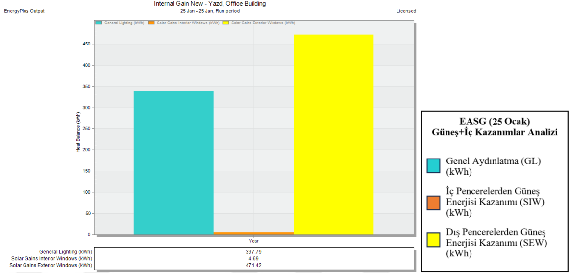
Şekil 4.20: KONF-2’de elde edilen EASG (25 Ocak) iç kazanımlar değerleri (Yazar tarafından Design Builder yazılımında üretilmiştir.)
