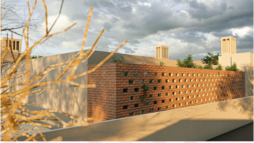
Şekil 3.17: YA-1 ve YA-2'ye bakan cepheler üzerinde parametrik boşluklu tuğlalı şeklinde duvar yapısı (Yazar tarafından Revit ve Lumion programlarında üretilmiştir.)
