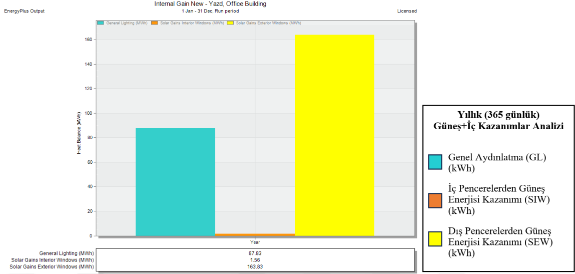
Şekil 4.36: KONF-4'te elde edilen yıllık (317 günlük) iç kazanımlar değerleri (Yazar tarafından Design Builder yazılımında üretilmiştir.)
