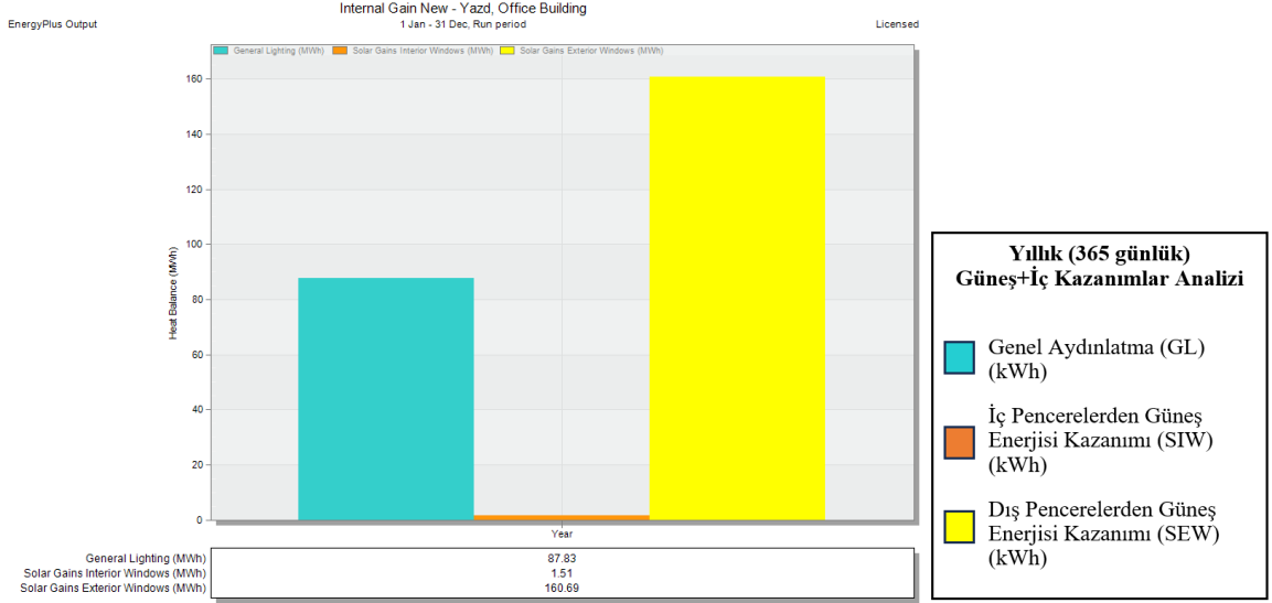
Şekil 4.46: KONF-5'te elde edilen yıllık (317 günlük) iç kazanımlar değerleri (Yazar tarafından Design Builder yazılımında üretilmiştir.)
