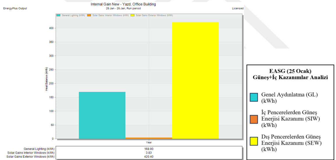
Şekil 4.60: KONF-6'da elde edilen EASG (25 Ocak) iç kazanımlar değerleri (Yazar tarafından Design Builder yazılımında üretilmiştir.)
