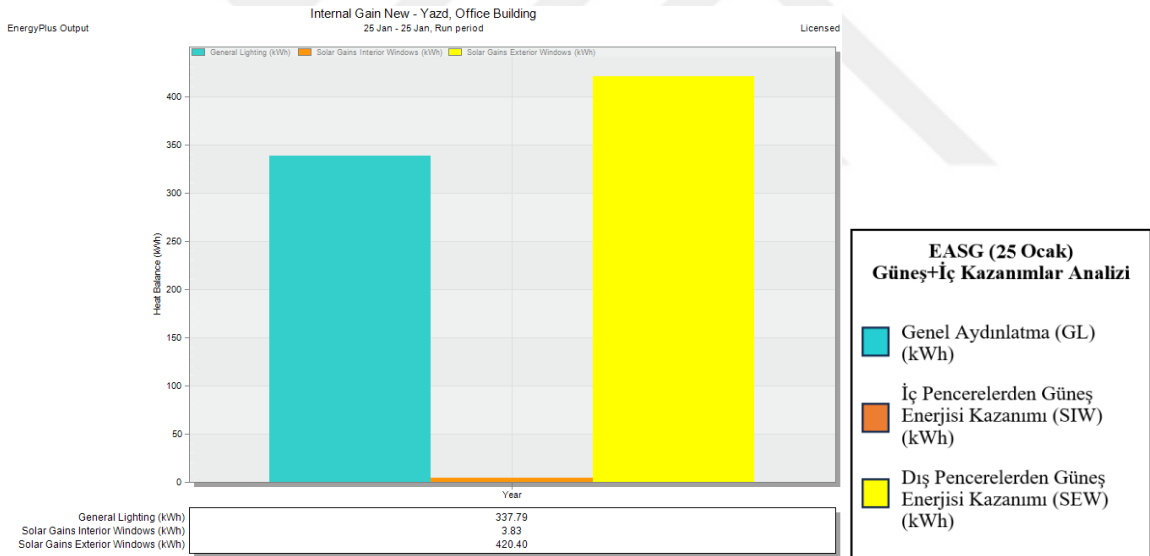
Şekil 4.50: KONF-5'te elde edilen EASG (25 Ocak) iç kazanımlar değerleri (Yazar tarafından Design Builder yazılımında üretilmiştir.)
