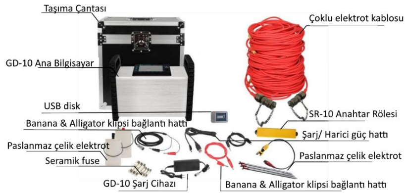
Şekil 4.5 Geomative GD-10 Rezistivite Cihazı ve ekipmanları
