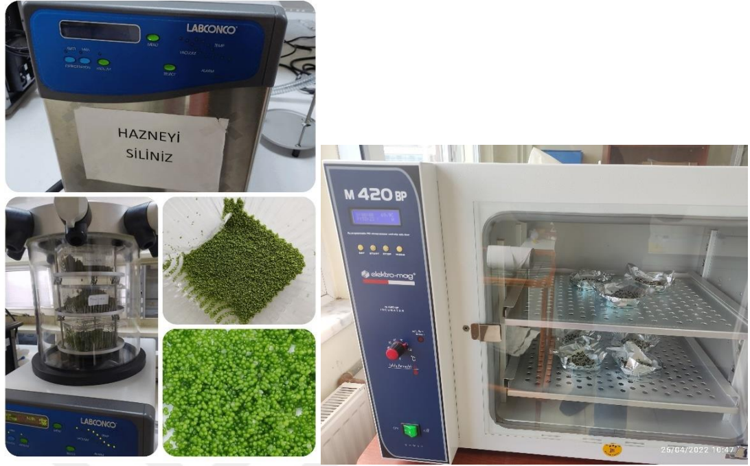
Şekil 3.4 W. arrhiza 'nın Liyofilizatörde (Solda) ve Etüvde (Sağda) Kurutma İşlemleri
