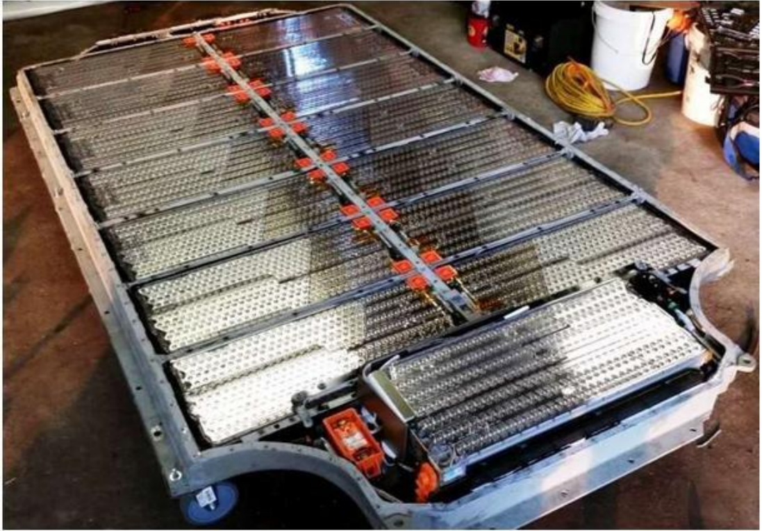
Şekil 2.17. Tesla Model S ait standart batarya paketi [30].
