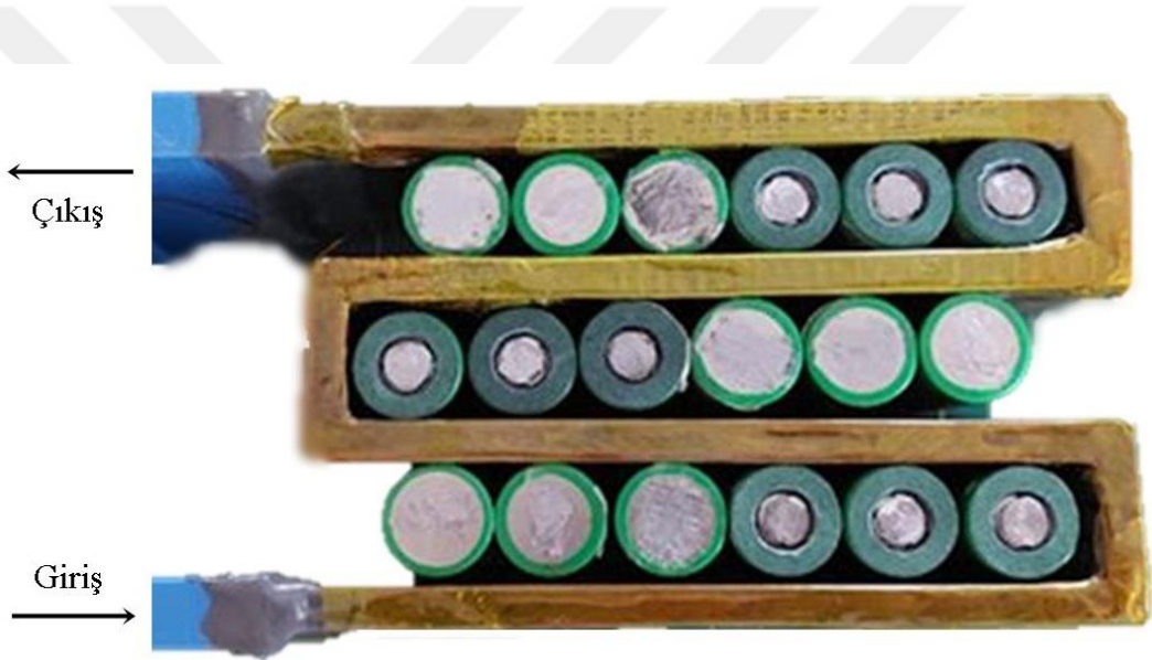
Şekil 3.1. Labirent tipi bir soğutma kanalı [36].
