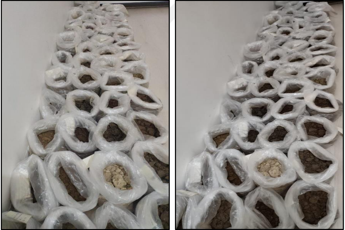
Fotoğraf 3: Alınan toprak numunelerin nemli olması durumunda herhangi bir bozulmaya maruz kalmaması için paketlerin kapalı olmamasına dikkat edilmelidir
