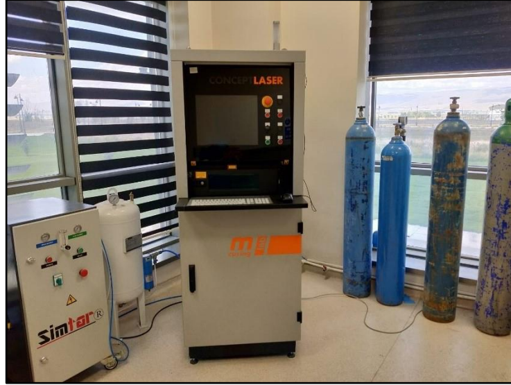
Şekil 3.4. Concept Laser MLab R seçici lazer ergitme cihazı
