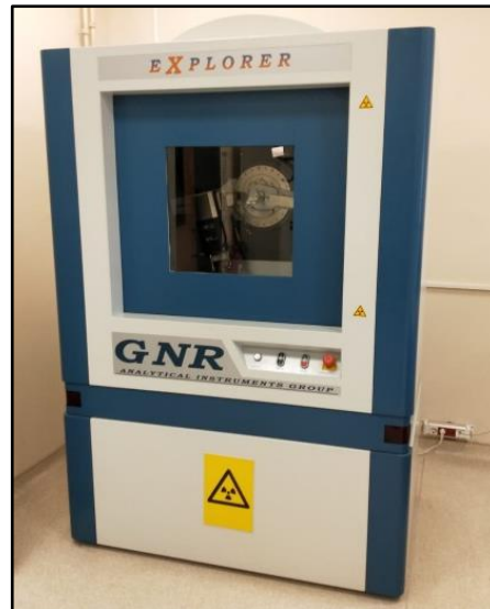
Şekil 3.13. GNR Explorer X-ışını difraksiyon cihazı
