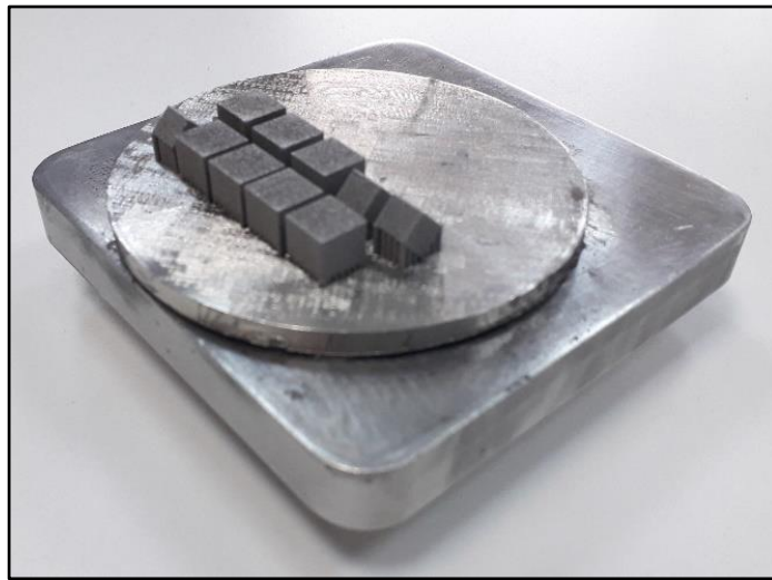
Şekil 4.45. WC-Ni+Ni toz malzemeye ait üretim görüntüsü
