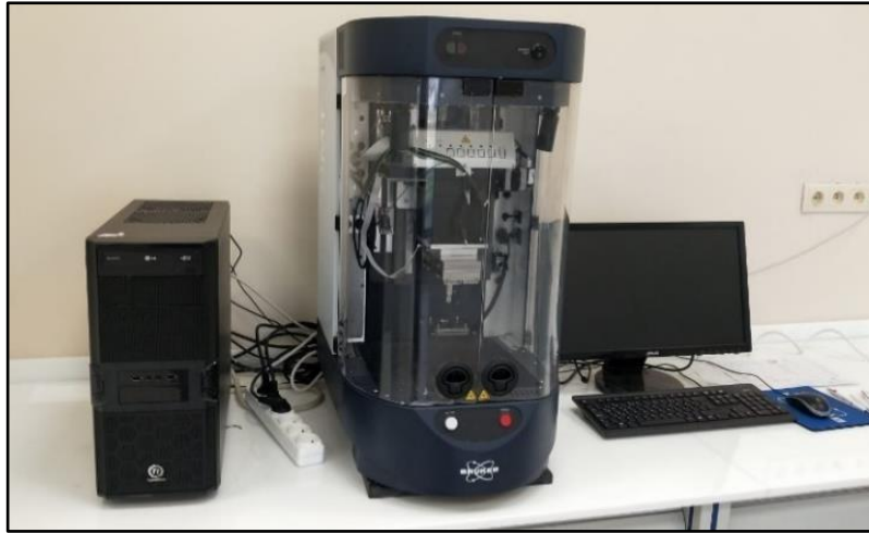
Şekil 3.16. Bruker - UMT markalı tribometre cihazı
