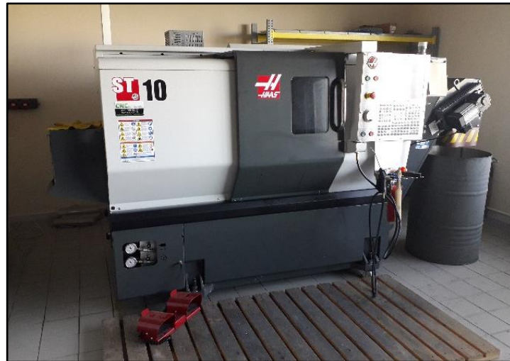
Şekil 3.21. Haas ST10 CNC torna tezgâhı
