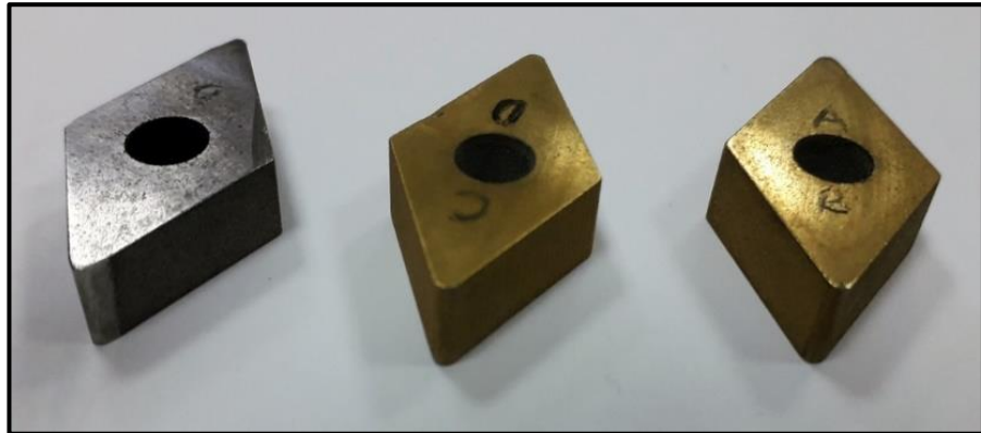
Şekil 4.57. Taşlanmış ve kaplamalı/kaplamasız kesici uçlar
