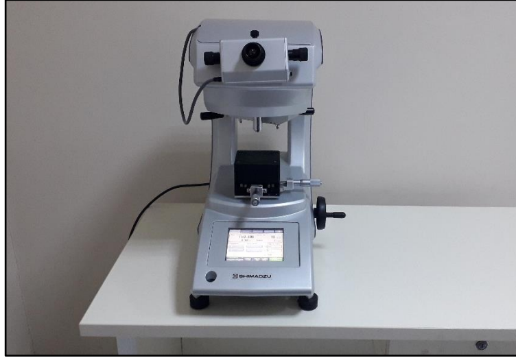
Şekil 3.15. SHIMADZU HMV-G20 markalı mikro sertlik cihazı
