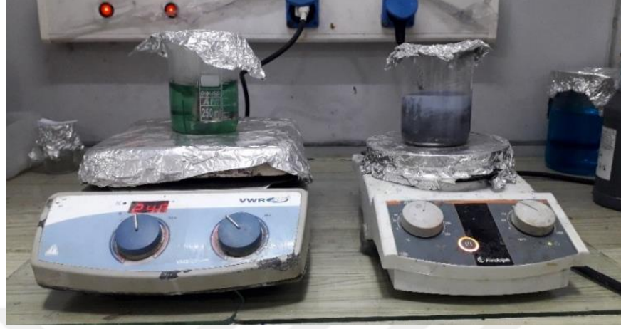
Şekil 3.2. WC toz parçacıklarının akımsız Ni kaplama işlemi
