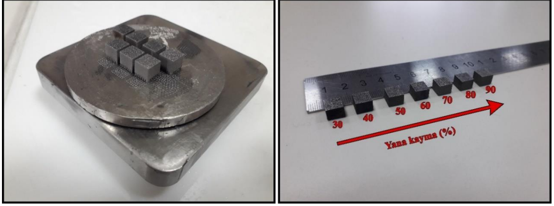
Şekil 4.21. WC-Ni toz malzemeden üretilen prizmatik numuneler
