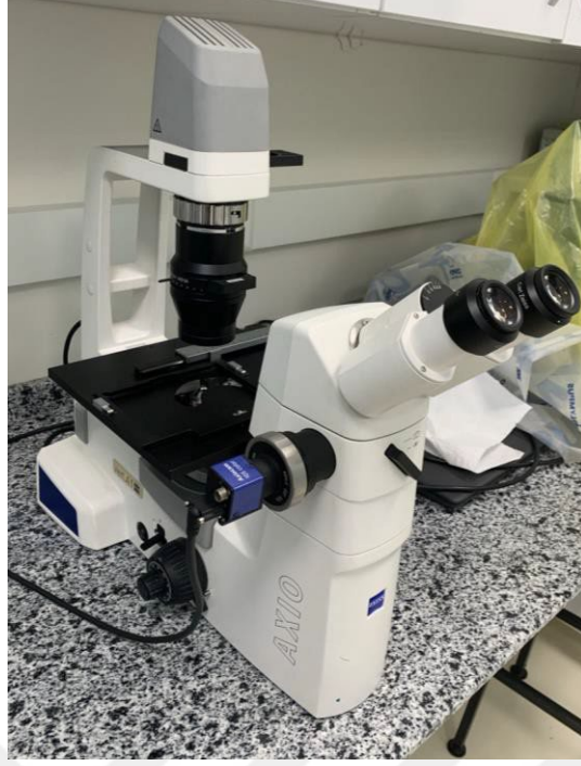
Fotoğraf 3.2. Hücrelerin fotoğraflanması amacıyla kullanılan inverted mikroskop (Bolu Abant İzzet Baysal Üniversitesi Tıp Fakültesi Farmakoloji Anabilim Dalı)
