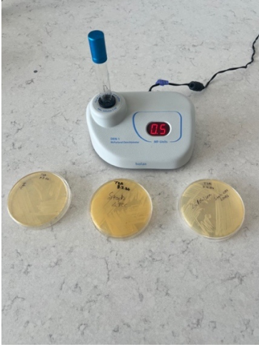
Şekil 3.3.1. Mikrodilüsyon yöntemi için McFarland 0,5 standart yokluğunda bakteri süspansiyonu hazırlanması
