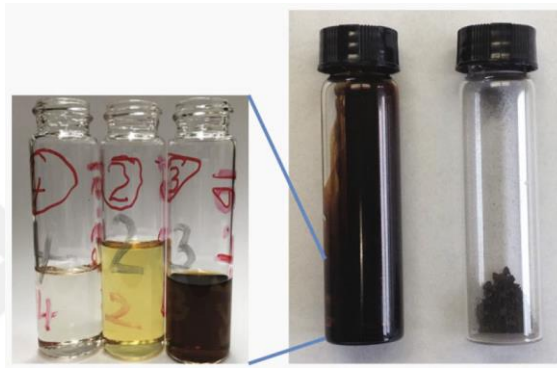
Şekil 1.2 : n-heptan kullanılarak ayrılan bir bitümlü bağlayıcıda asfaltın (sağda) ve malten (ortada) fraksiyonları; malten sonrasında aromatik ve reçine olarak ayrılmış [85]
