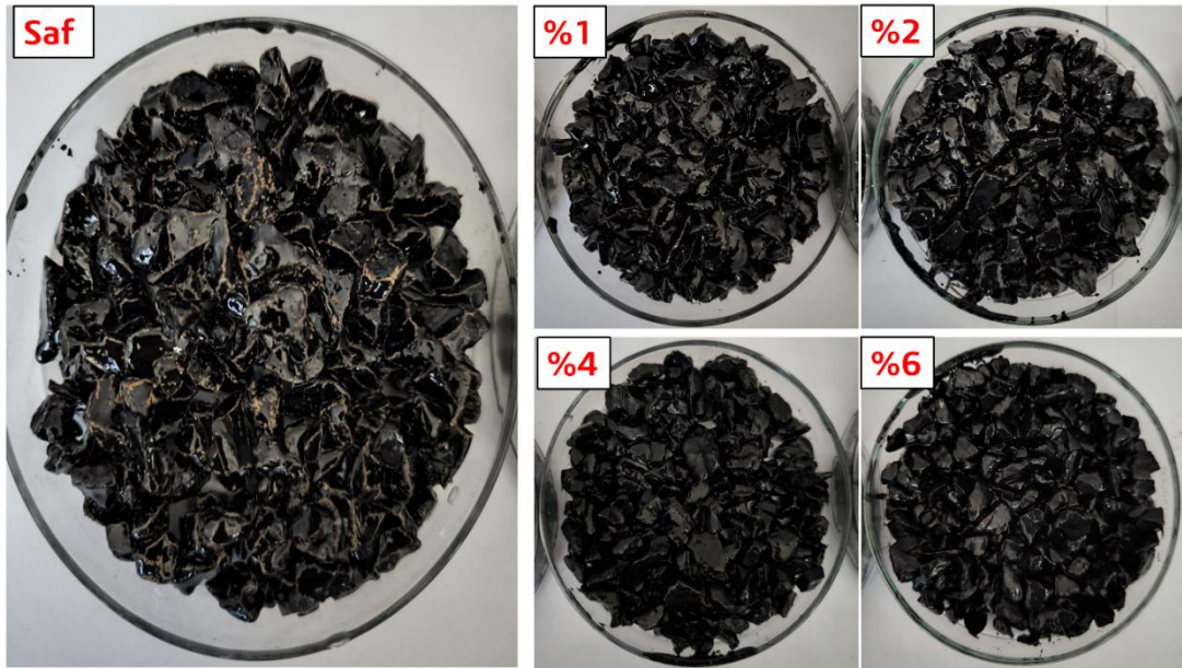
Şekil 3.59 : Nicholson soyulma deneyi sonrası numunelerin görüntüsü
