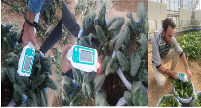
Şekil 3.19 Ispanak yapraklarında LI-600 florometre cihazı ile yapılan ölçümlerden görüntüler (Orjinal)
