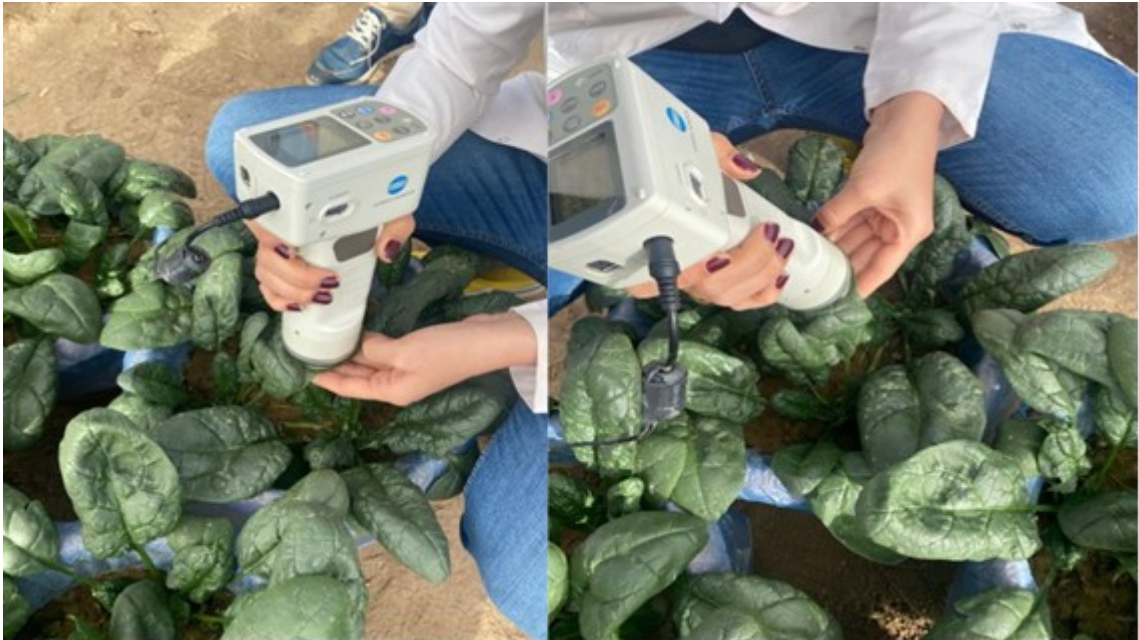
Şekil 3.20 Ispanak yapraklarında CR-400 renk cihazı ile yapılan ölçümlerden görüntüler (Orjinal)
