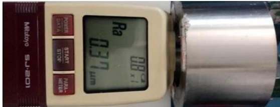
Resim 6.15. Yüzey pürüzlülük ölçüm cihazı ile yüzey pürüzlülüğü ölçümü
