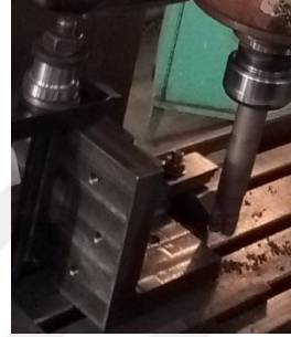
c. Freze tezgahında istenilen ölçülere getirilmesi
