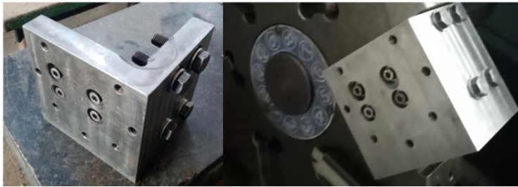
Resim 6.11. Dinamometre bağlama aparatının CNC tezgâhına montajı
