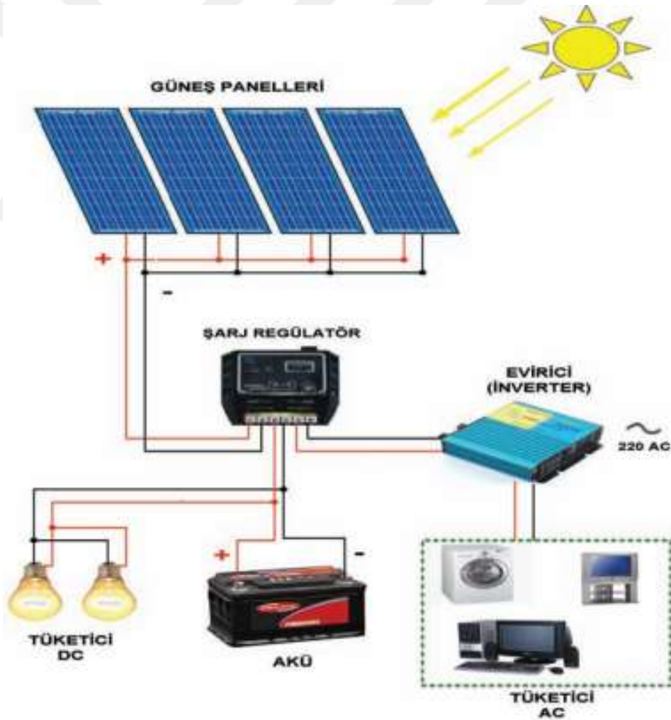
Şekil 2.7. Güneş panel sistemini oluşturan temel donanımlar (Köroğlu vd 2010)
