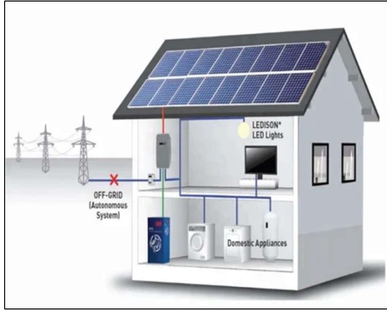
Şekil 3.2. Şebekeden bağımsız sistemler (Off-Grid sistem) örnek uygulama gösterimi
