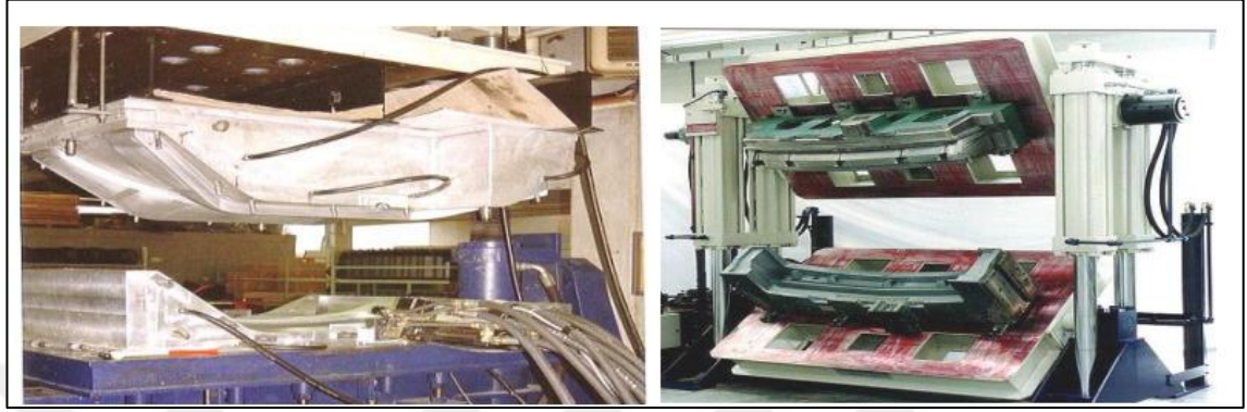
Şekil 2.4. RIM prosesi ile parça üretimi (Akdoğan, 2011)
