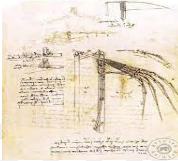
Şekil 9: Leonardo da Vinci'nin eklemli kanat çalışması
