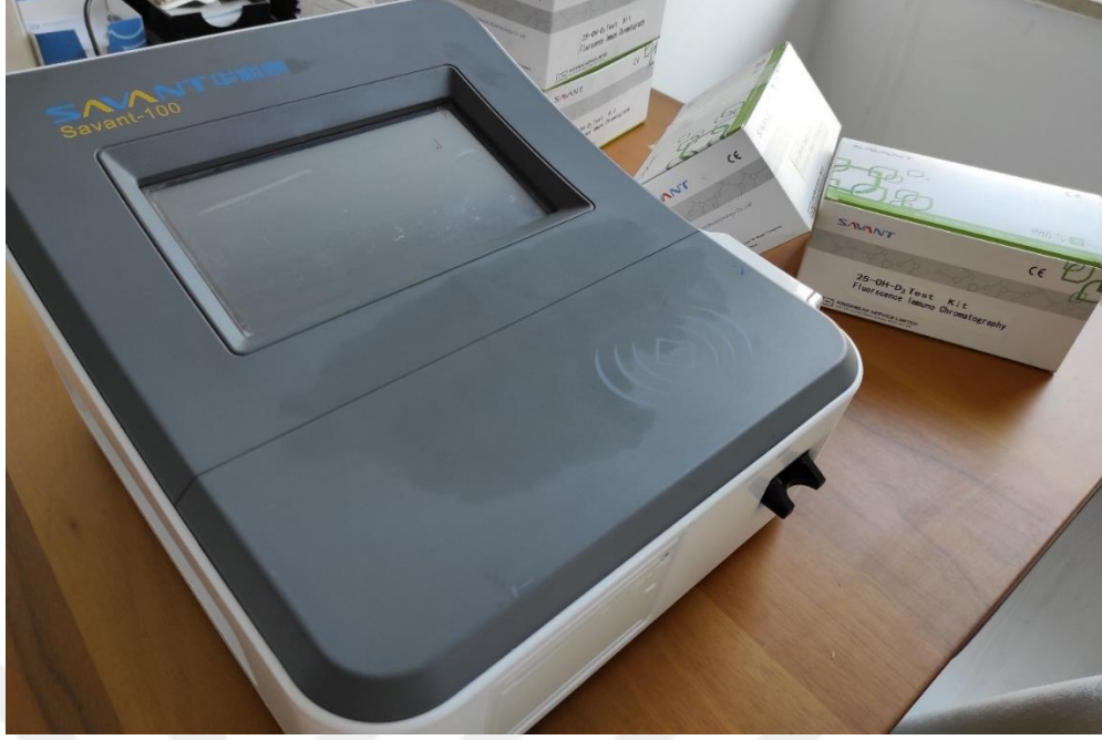
Şekil 3.3. 25 (OH) D3 analizinde kullanılan Savant flöresan immunoassey cihaz
