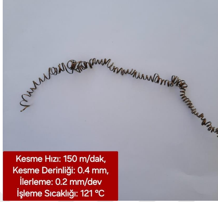
Şekil 5.2. Kesme hızı: 150 m/dak, kesme derinliği: 0.4 mm ve ilerleme: 0.2 mm/dev parametreleriyle yapılan en düşük kesme kuvvetinin ölçüldüğü, kesme bölgesindeki sıcaklığın 121 °C bulunduğu kuru tornalama deneyi sonucunda meydana gelen talaşın görüntüsü
