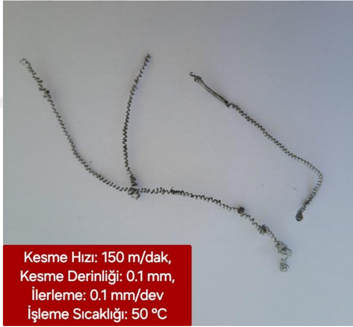
Şekil 5.1. Kesme hızı: 150 m/dak, kesme derinliği: 0.1 mm ve ilerleme: 0.1 mm/dev parametreleriyle yapılan en düşük kesme kuvvetinin ölçüldüğü, kesme bölgesindeki sıcaklığın 50 °C bulunduğu kuru tornalama deneyi sonucunda meydana gelen talaşın görüntüsü
