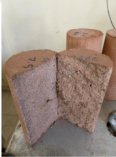
Şekil 3.15 Deney sonrası eksen boyunca yarıma gözlenen bazalt lif içerikli geopolimer harç numunesi
