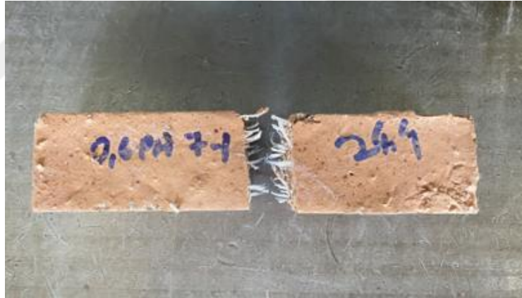
Şekil 4.9 Poliamid lif kullanılan geopolimer harç numunesine ait görsel
