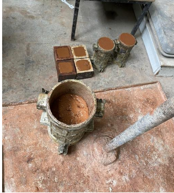
Şekil 3.39 Titreşim tablası üzerinde 3 aşamada dökümü yapılan numune örneği
