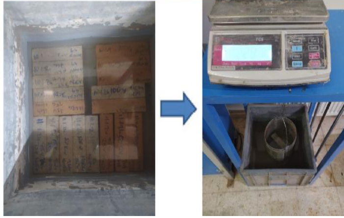
Şekil 4.4. Su Emme ve Boşluk Ölçüm Deneyi
