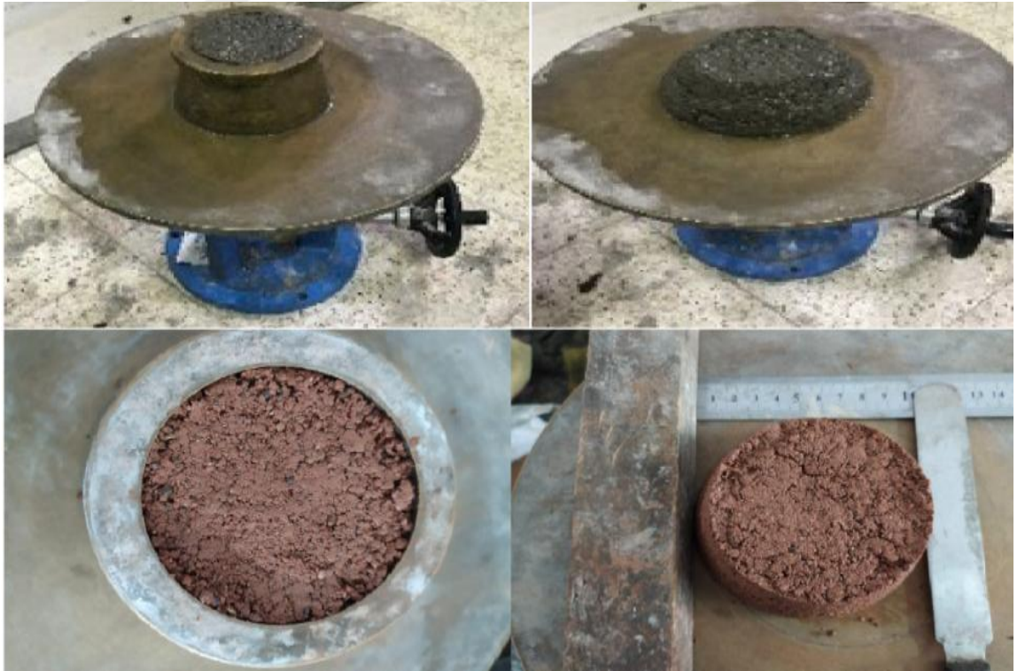
Şekil 4.1. Yayılma Tablası (İşlenebilirlik) Deneyi
