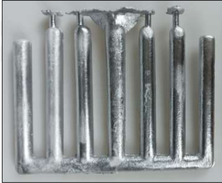
Şekil 25: Mekanik Test Kalıbı Döküm Numune Örnek Görüntüsü
