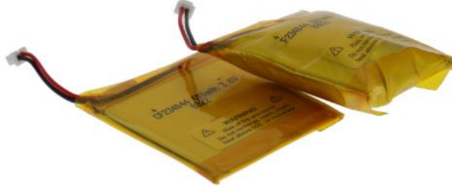
Şekil 2.3. Deformasyona uğrayan kese tipi hücre (EPEC, 2024)
