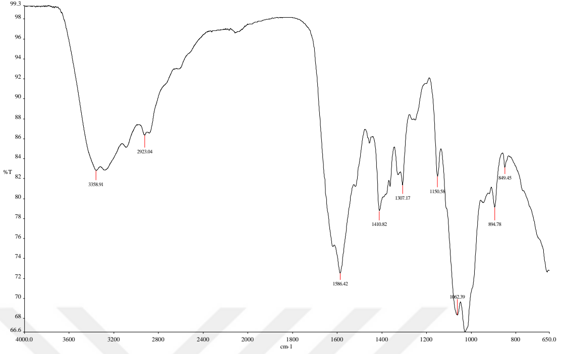
Şekil 51: İpek proteini ve Kitosan karışımı FTIR Spektrumu
