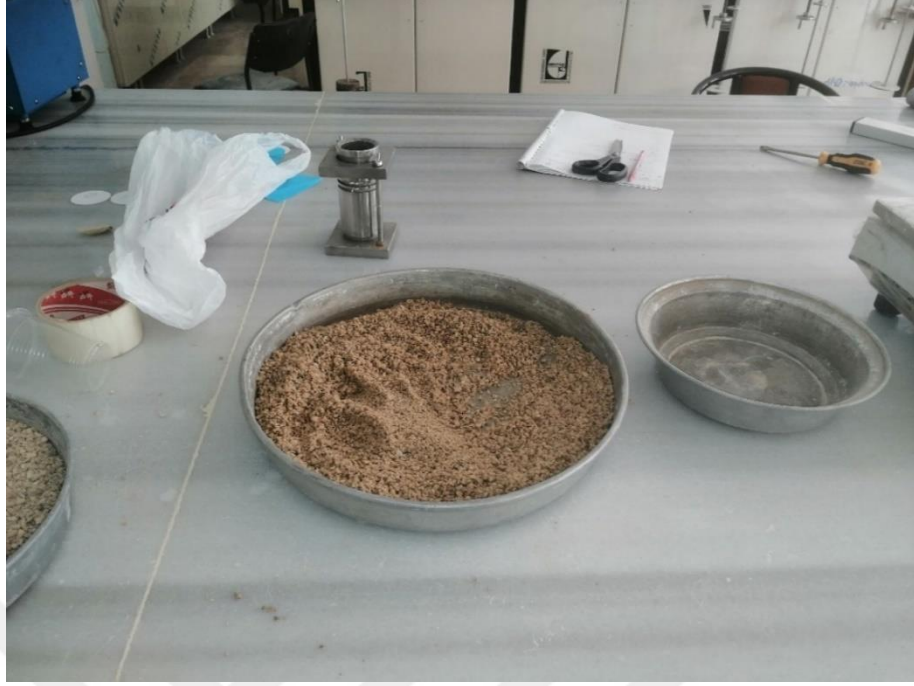
Şekil 3.66. Kesme kutusu deneyi için Optimum su içeriğinde karıştırılmış zemin
