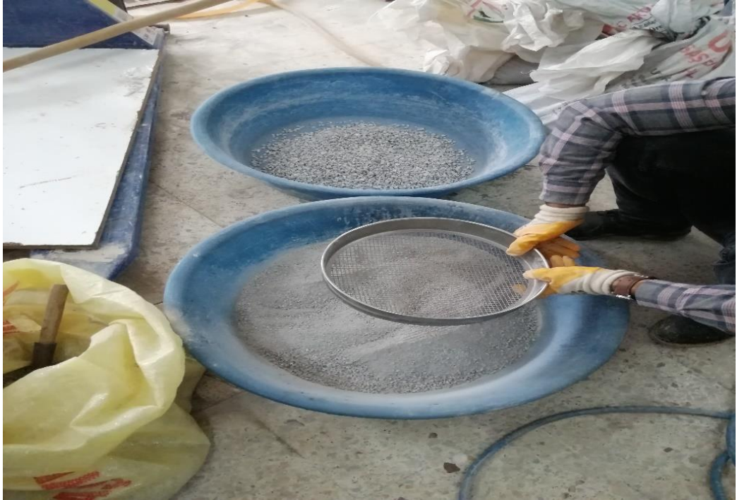
Şekil 3.57. GDBA'ların kum boyutunda elenmesi
