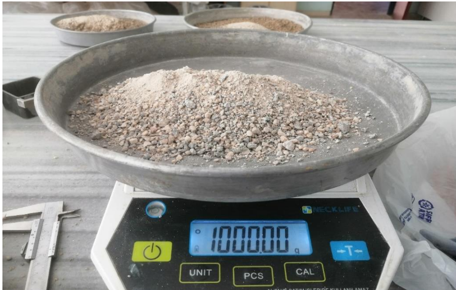
Şekil 3.65. Kesme Kutusu Deneyi için zeminin hazırlanması
