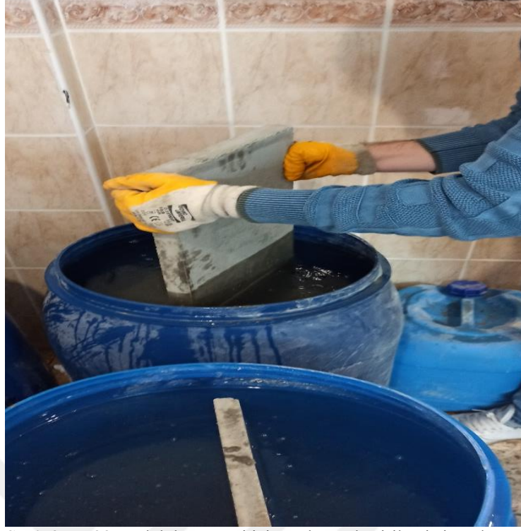
Şekil 3.89. 28 günlük kür süresi için tanka yerleştirilen istinat duvarı
