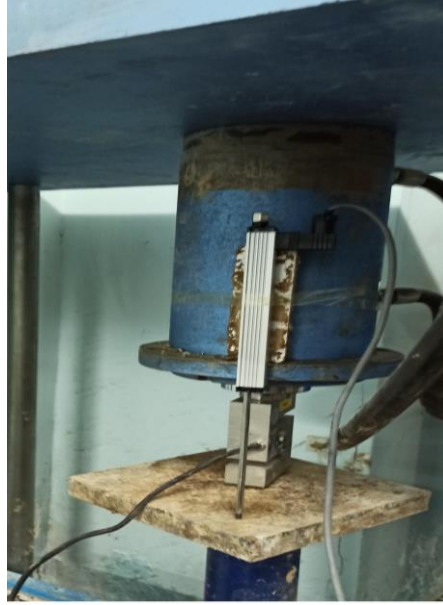
Şekil 3.95. Potansiyometrik cetvel ile oluşturulan düşey deformasyon ölçüm düzeneği
