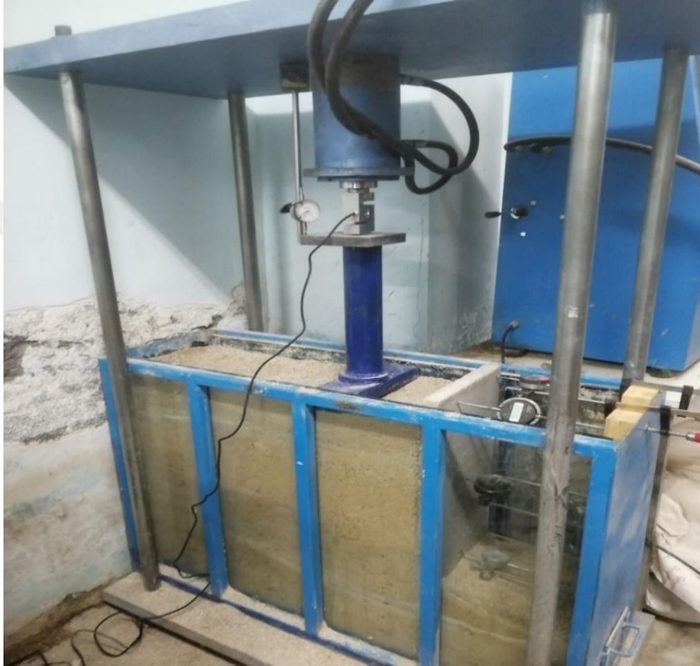
Şekil 3.101. Tankın yüklenmesi ve deney aletlerinin yerleştirilmesi
