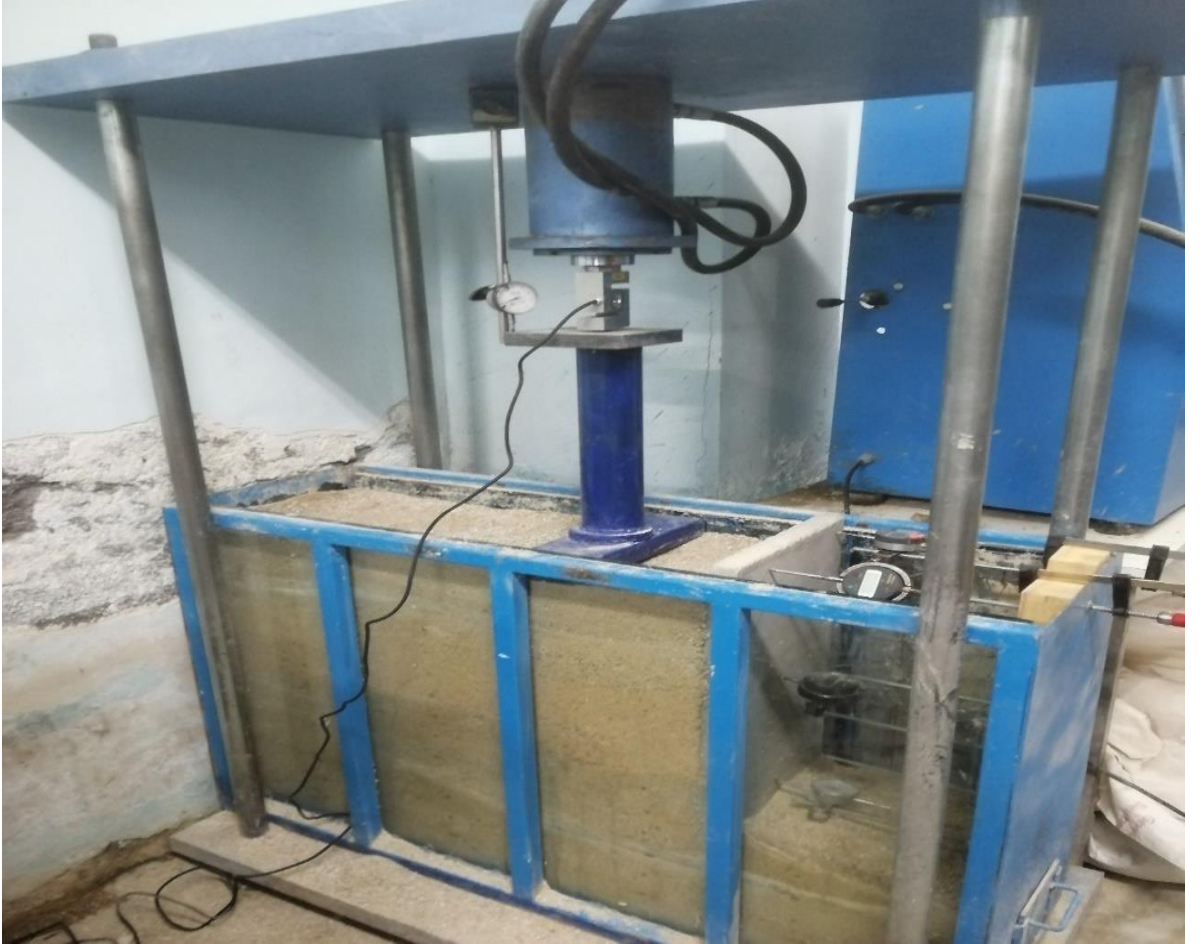
Şekil 4.15. Geri dolgu malzemesi %20 GDBA + %80 DA olan istinat duvarında yükleme deneyi
