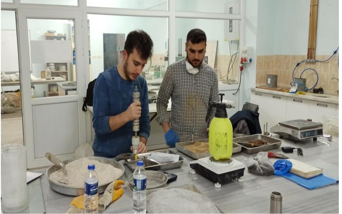
Şekil 3.64. Laboratuvarda mini (Harvard) proktor deneyinin yapılması
