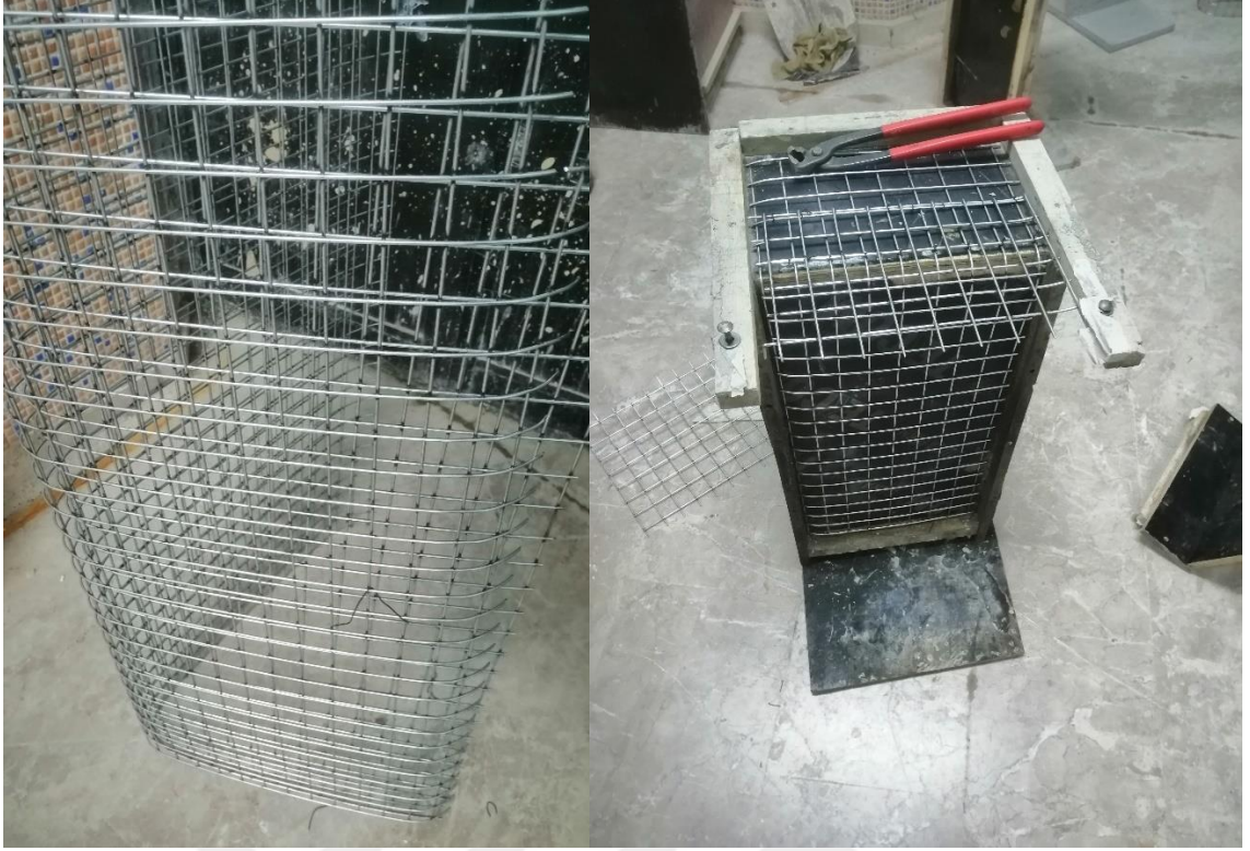
Şekil 3.74 Model istinat duvarının oluşturulmasında puntolanmış donatı kafesi
