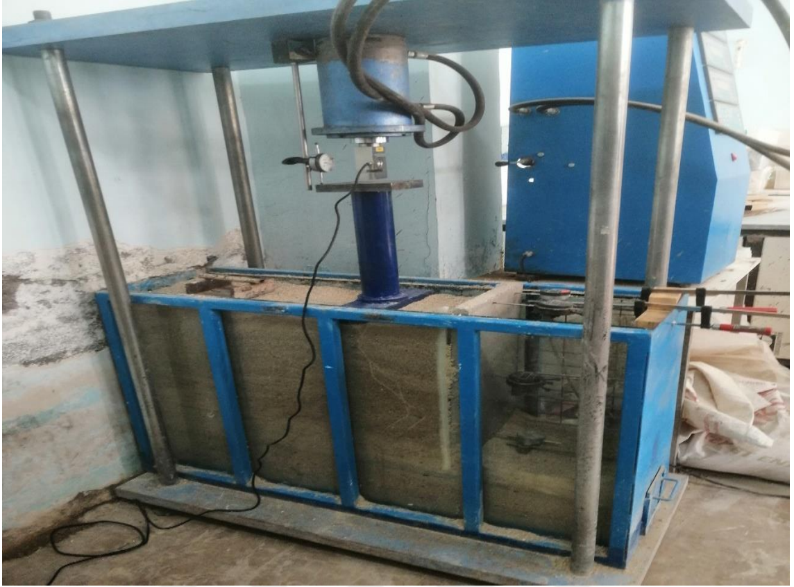
Şekil 4.13. Geri dolgu malzemesi %100 DA olan istinat duvarında yükleme deneyi
