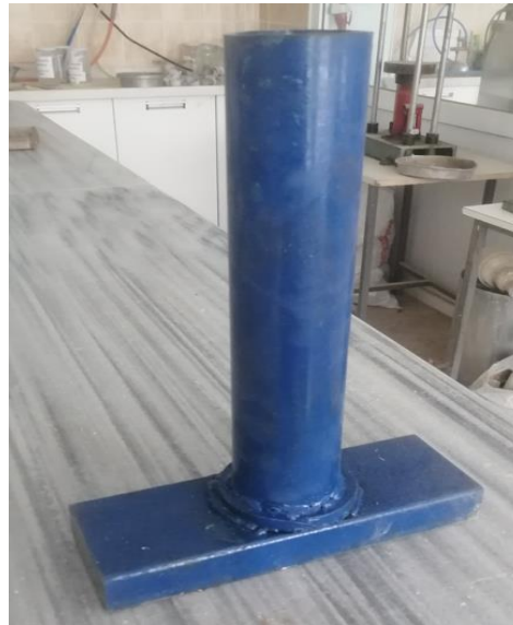
Şekil 3.92. Tank içerisindeki yüklemelerin gerçekleştirildiği model temel
