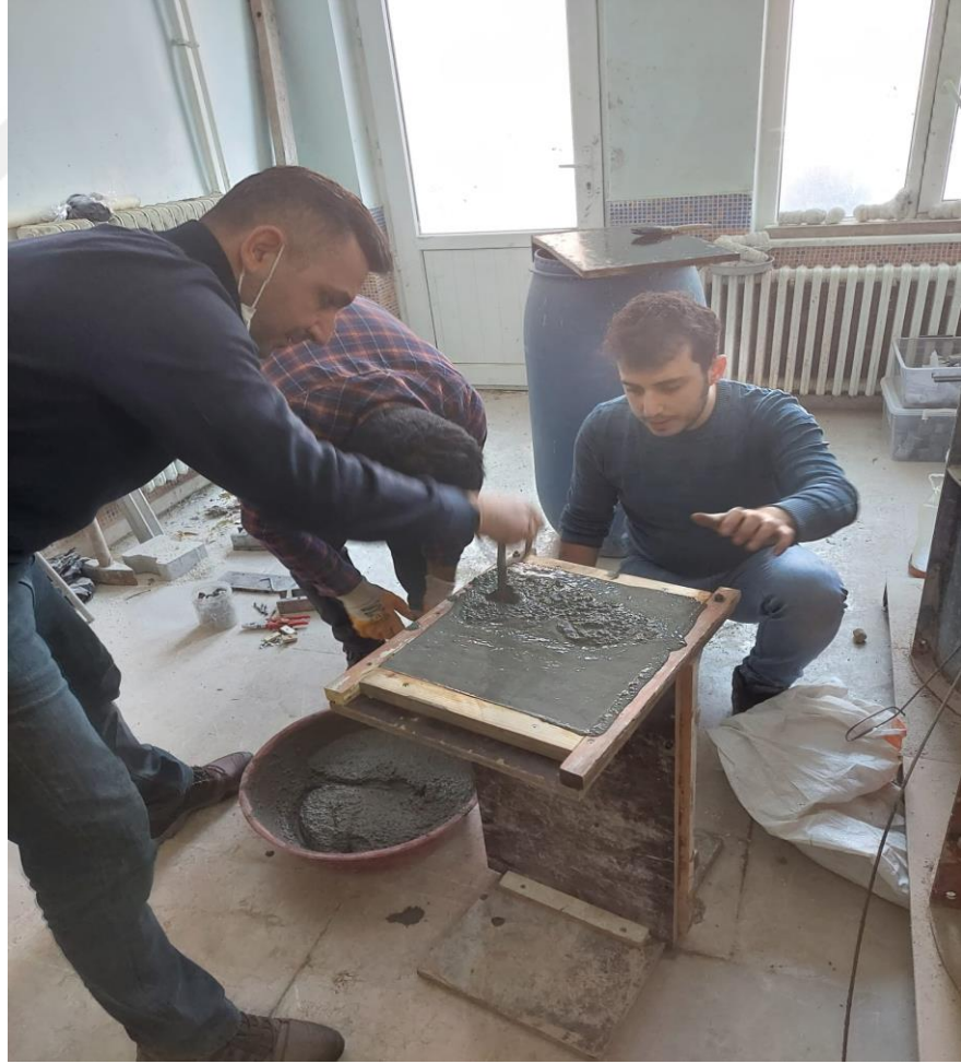
Şekil 3.82. Harcın kalıba yerleştirilmesi ve şişlenmesi
