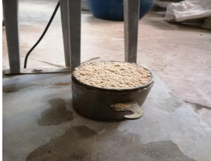
Şekil 3.60. Proktor kalıbı ile kuru birim hacim ağırlıklık, min. ve max. boşluk oranlarının belirlenmesi
