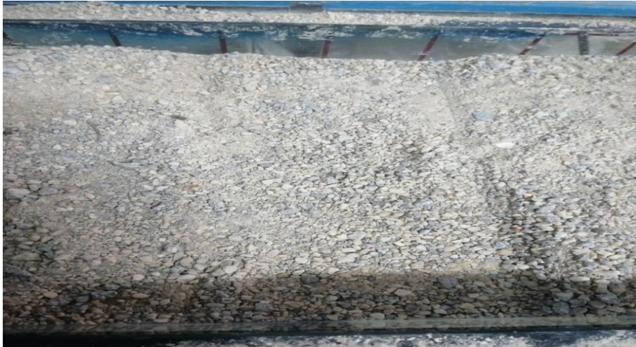
Şekil 4.19. Geri dolgu malzemesi %60 GDBA+%40 DA olan istinat duvarında yükleme deneyi
