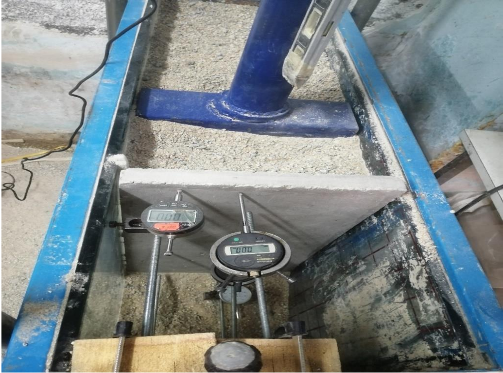
Şekil 4.17 Geri dolgu malzemesi %40 GDBA +% 60 DA olan istinat duvarında yükleme deneyi
