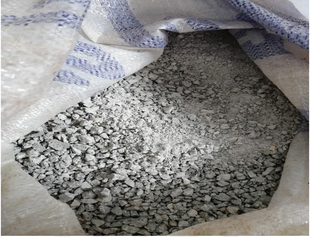
Şekil 3.56. Çeneli kırıcı yardımıyla küçültülen GDBA
