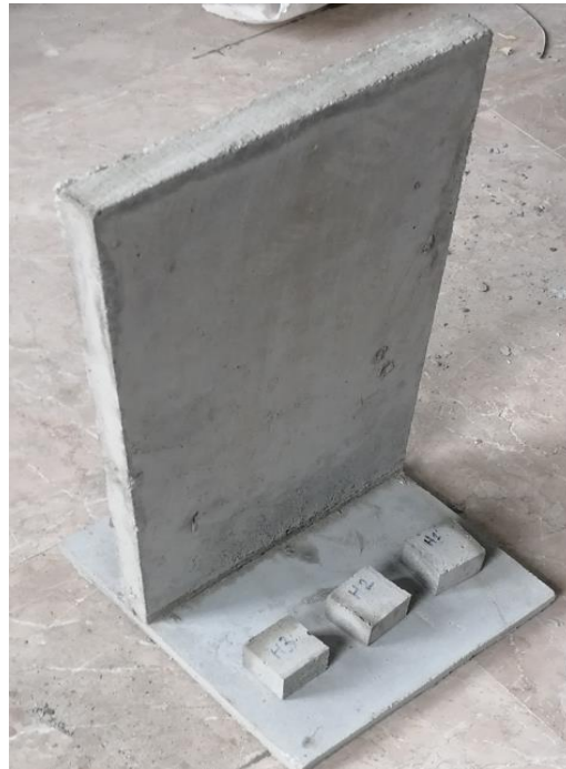
Şekil 3.86. Kalıptan çıkan istinat duvarı ve küp numuneler
