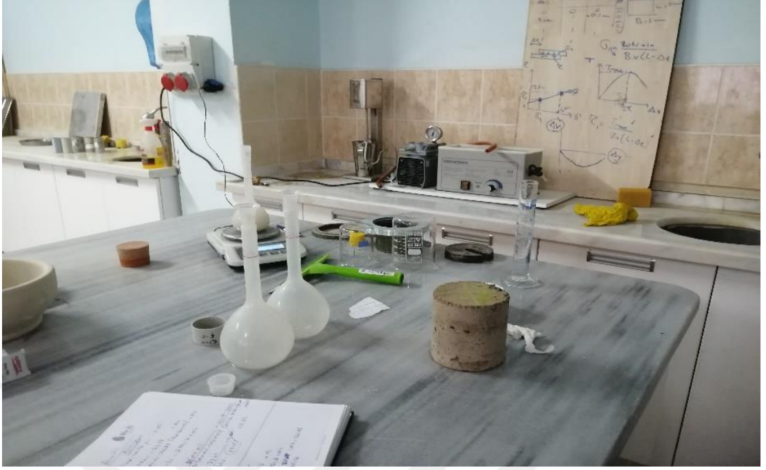
Şekil 3.69. Laboratuvarda piknometre deneyinin yapılması
