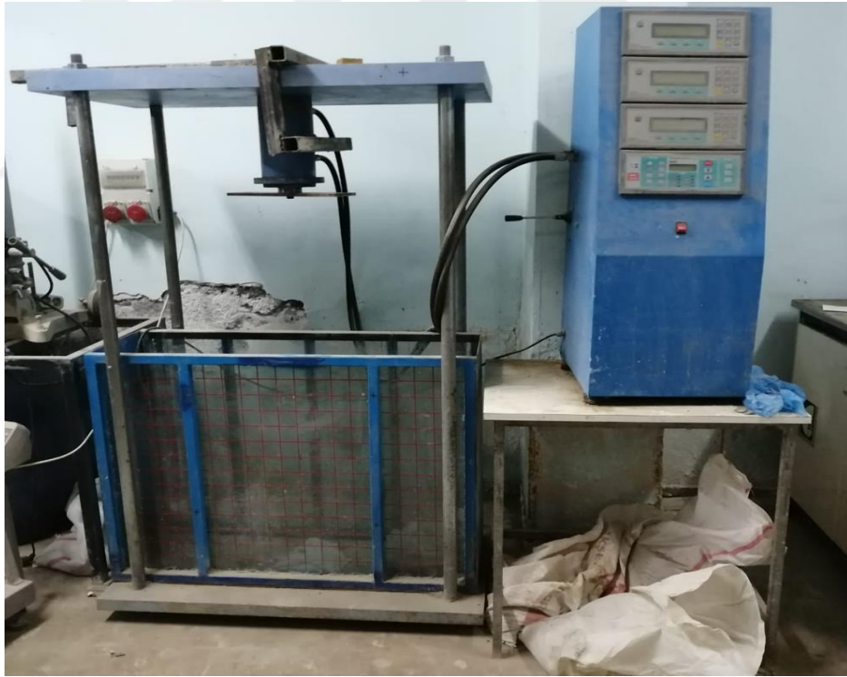
Şekil 3.72. Laboratuvarda yükleme deneylerinin yapıldığı tank düzeneği (Demiröz, 2008)
