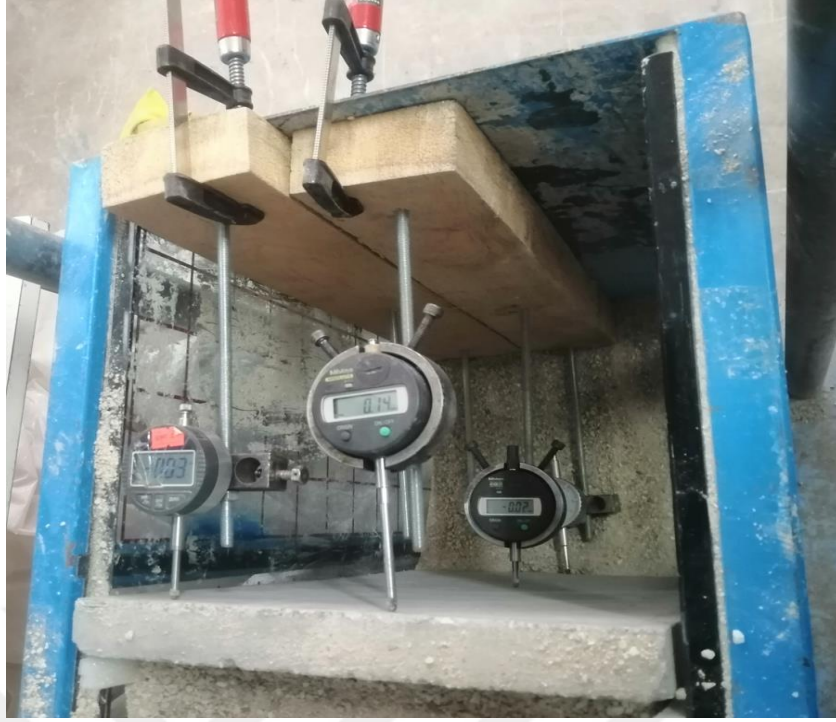
Şekil 3.94. Tank içerisine yerleştirilen deformasyon saatleri
