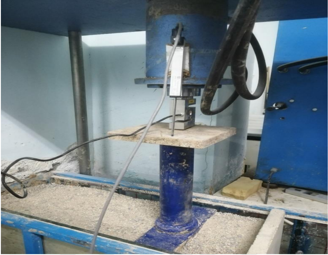
Şekil 4.24. Geotekstil kullanılarak oluşturulan yükleme sistemi için ölçüm aletleri
