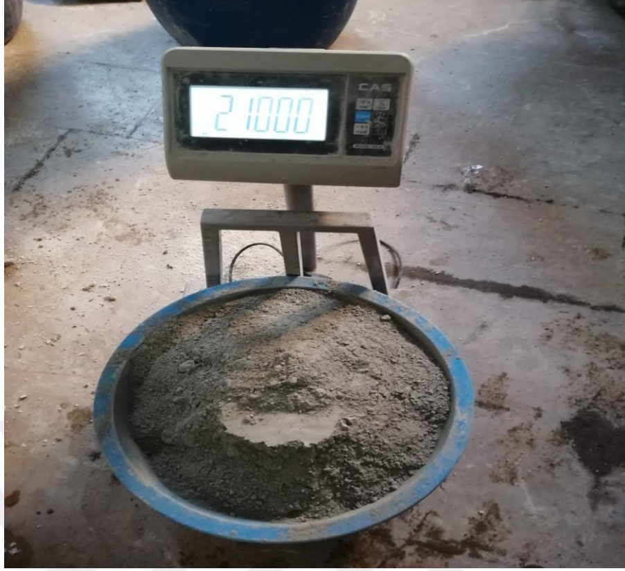
Şekil 3.79. Çimento ve agrega karışımının oluşturulması
