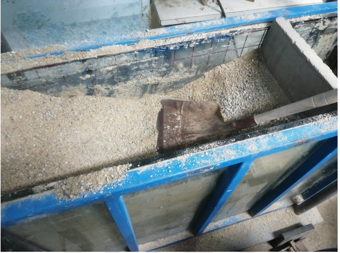
Şekil 3.105. Deney sonrası duvar arkası geri dolgusunun boşaltılması
