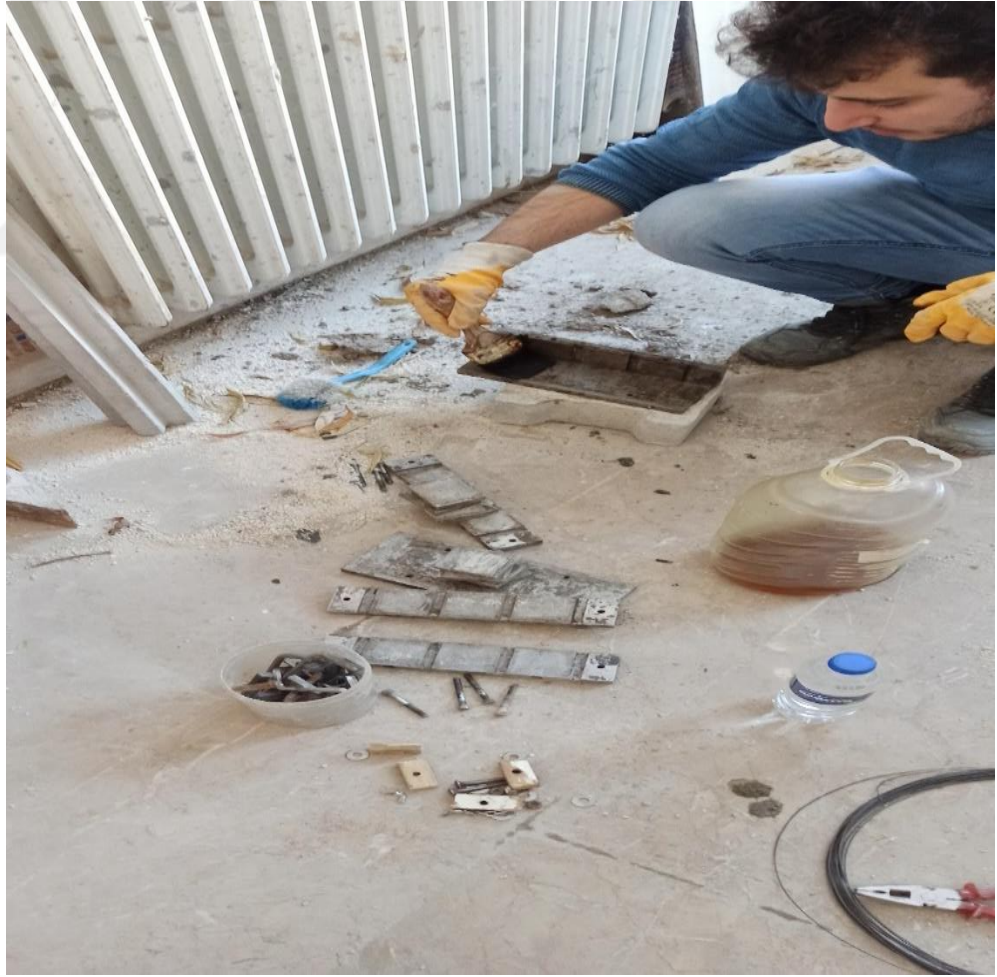
Şekil 3.84. Serbest basınç deneyi için küp numune kalıplarının yağlanması
