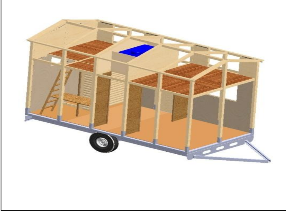
Şekil 4.10. Prototip ahşap mobil evde asma kat bölme detayı
