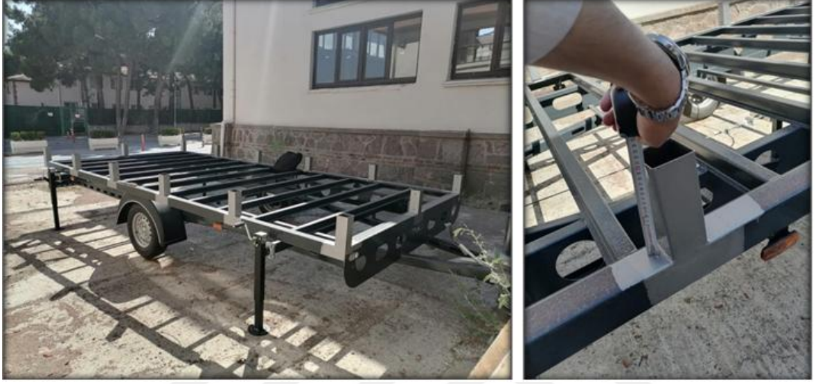
Resim 4.1. Taşıyıcı römork üzerine ankraj ünitelerinin kaynatılma işlemi
