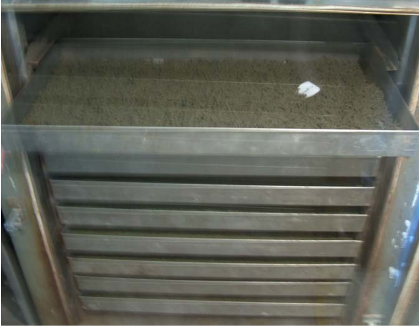
Şekil 3.3. Peletlenen yemlerin yem fırınında kurutulması.
