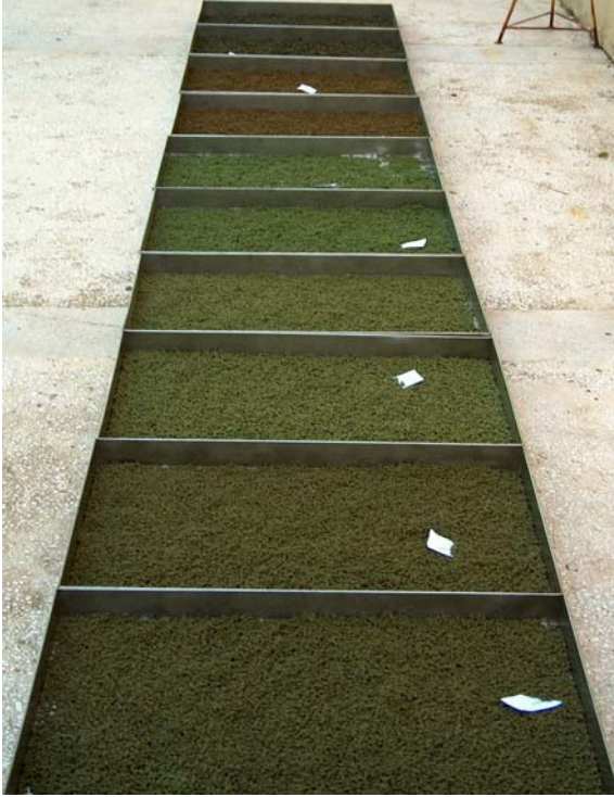
Şekil 3.2 Hazırlanan peletlerin kurutma tepsilerine yerleştirilmesi.
