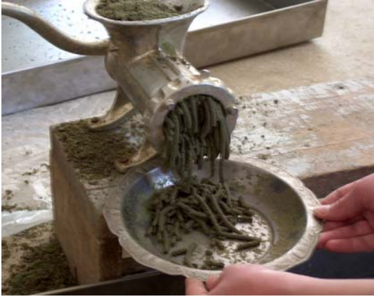
Şekil 3.1. Hamur haldeki yem materyalinin kıyma makinesinden geçirilerek pelet haline getirilmesi.
