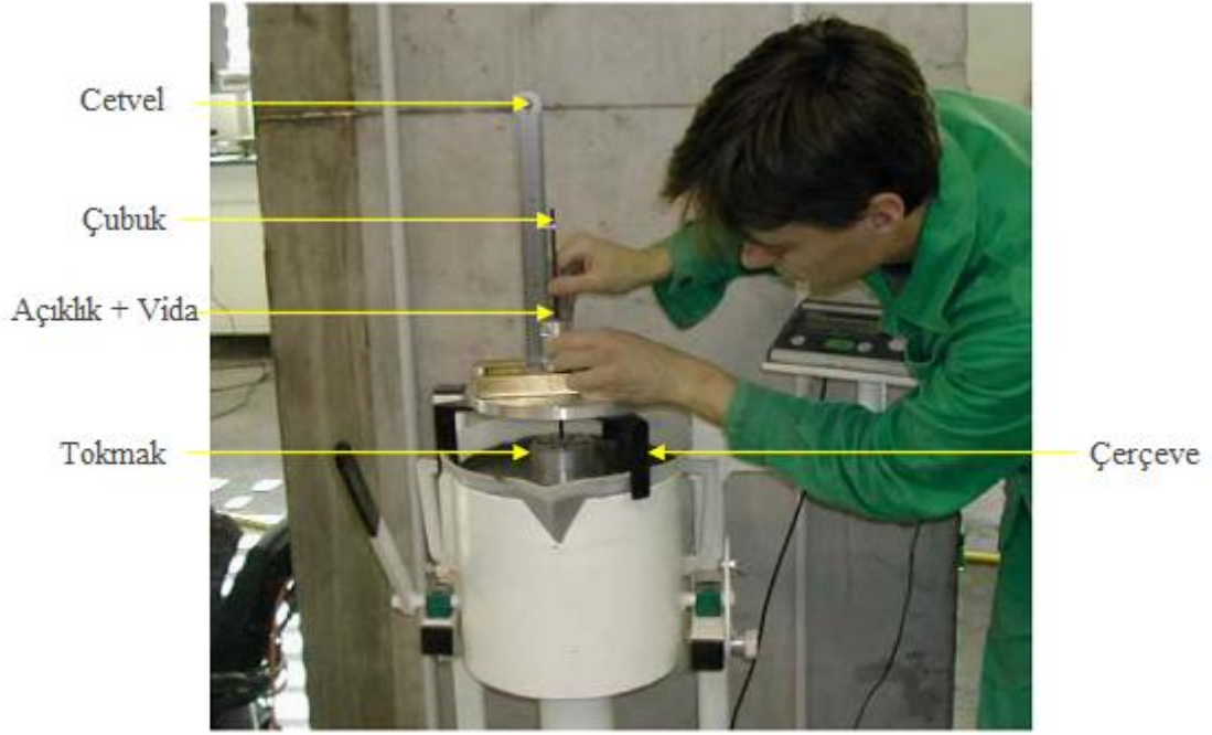
Şekil 1.14 Penetrasyon testi aleti kullanımı
