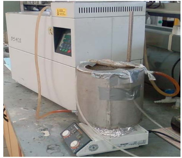
Antibiyotik içeren aerobik reaktör (3 L)
