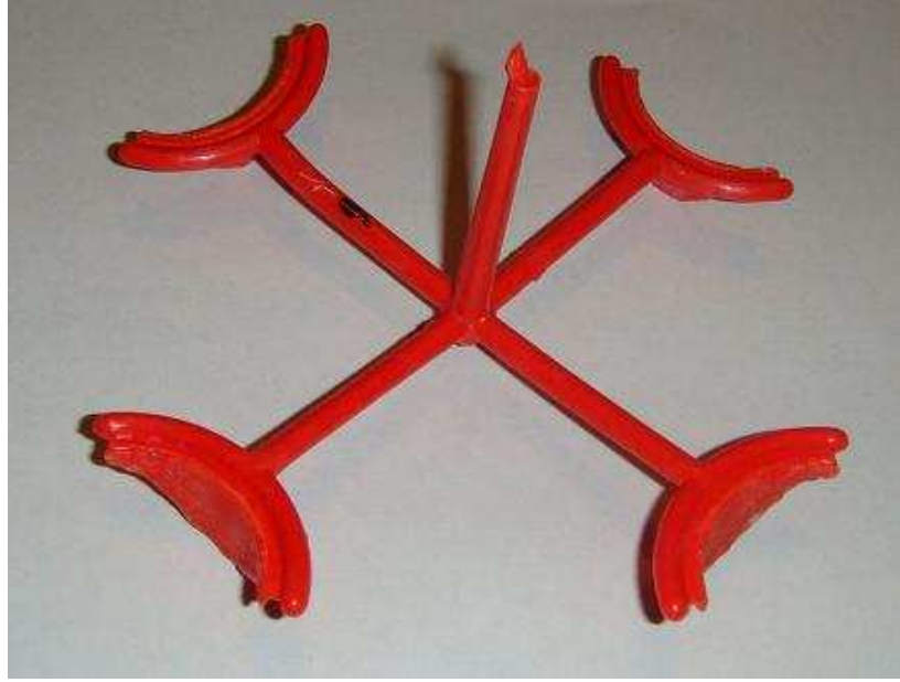
Şekil VII.16. Kalıbın 0.2 Saniyedeki Dolumu
