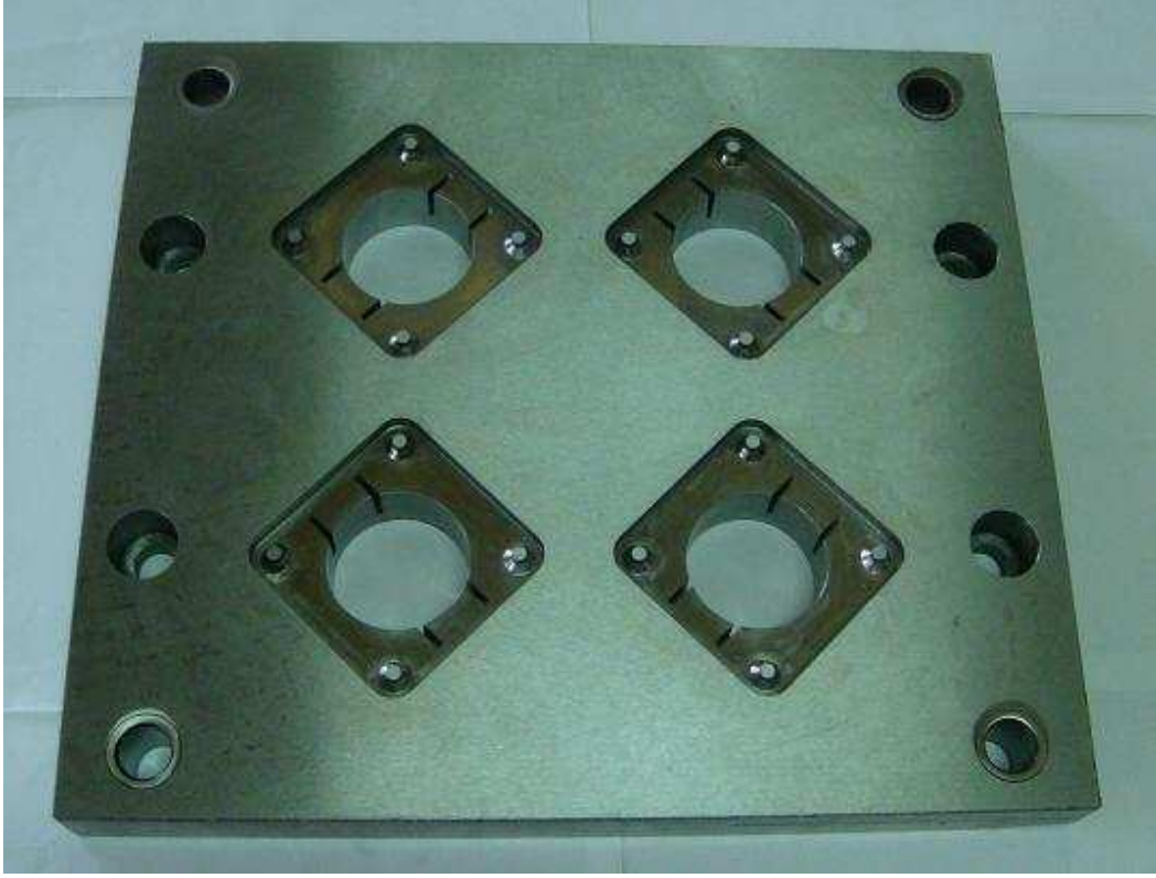
Şekil VII.8. Dişi Çelik Üzerindeki Ürün Figürü
