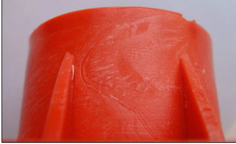
Şekil VII.26. Soğuk Kaynak İzi
