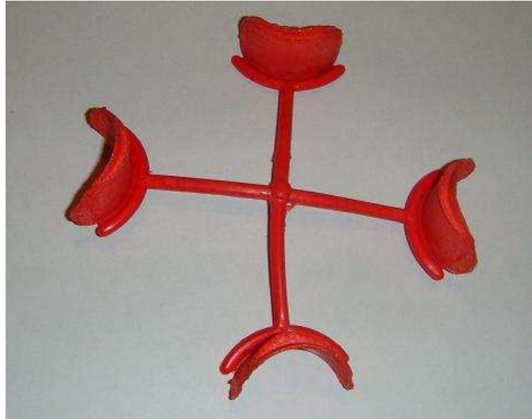
Şekil VII.17. Kalıbın 0.3 Saniyedeki Dolumu
