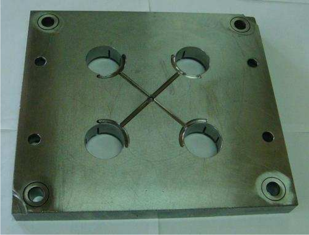
Şekil VII.9. Dişi Çelik Üzerindeki Yolluk Dağıtıcı Kanalları
