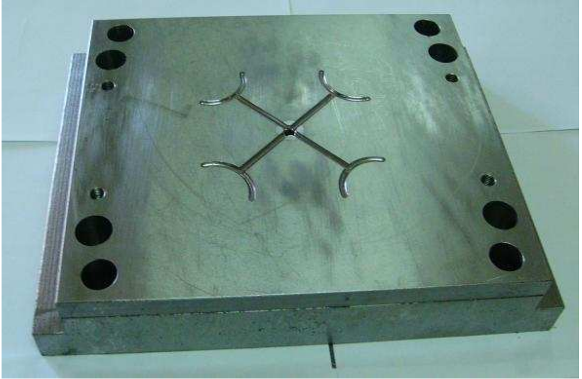
Şekil VII.7. Üst Bağlantı Plakası Üzerindeki Yolluk Dağıtıcı Kanalları
