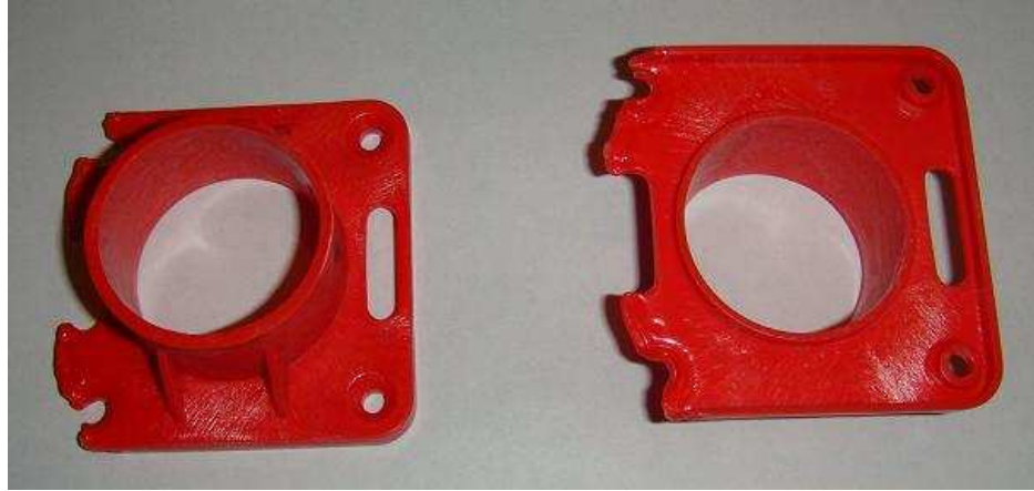
Şekil VII.20. Kalıbın 0.9 Saniyedeki Dolumu
