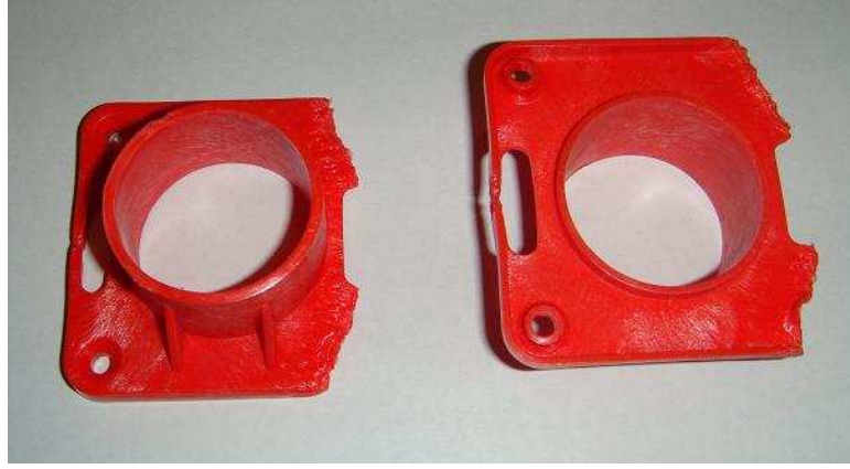
Şekil VII.19. Kalıbın 0.8 Saniyedeki Dolumu
