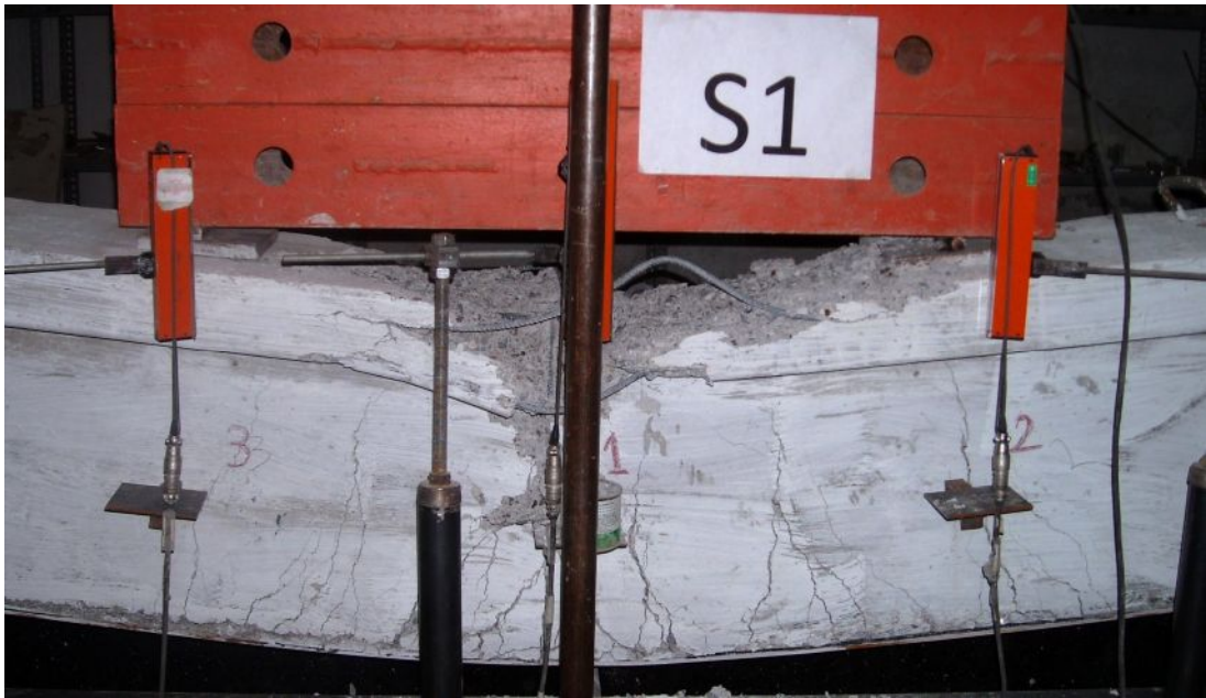
Resim 4.19. S1 deney elemanı deney sonunda hasar durumu
