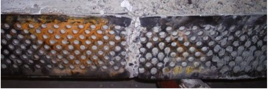
Resim 4.42.S10 deney elemanı kopan levha
