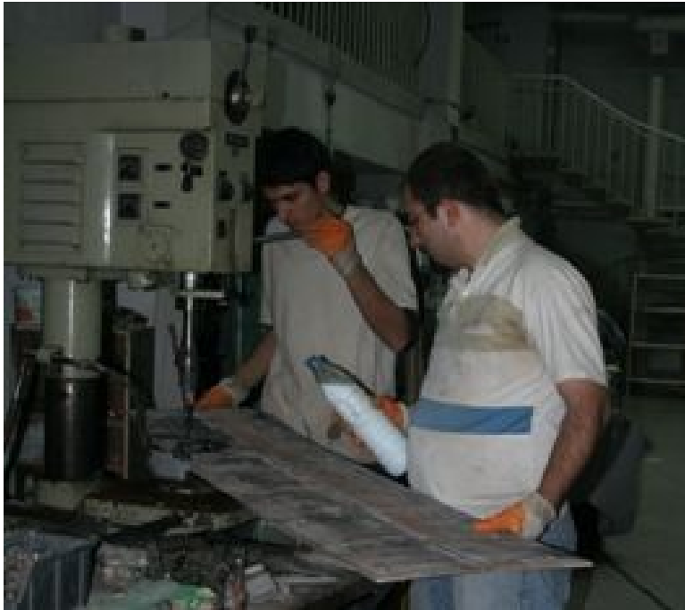
Resim 4.7. Basınç levhası deliklerinin açılması
