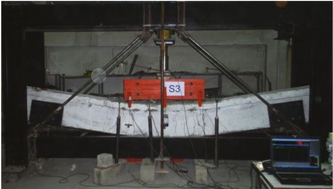
Resim 4.24. S3 elemanında görülen hasarlar
