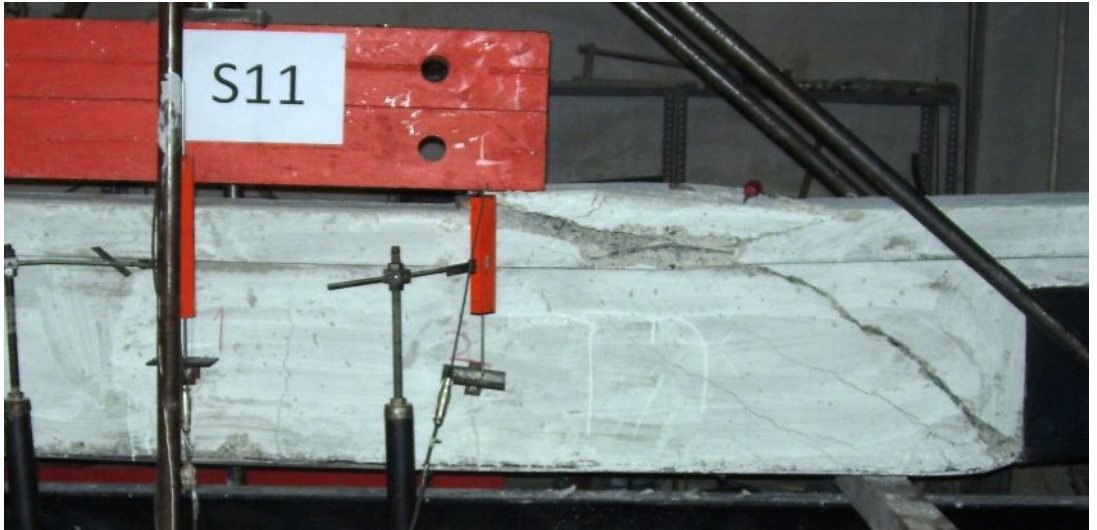
Resim 4.44.S11 deney elemanındaki kesme kırılması
