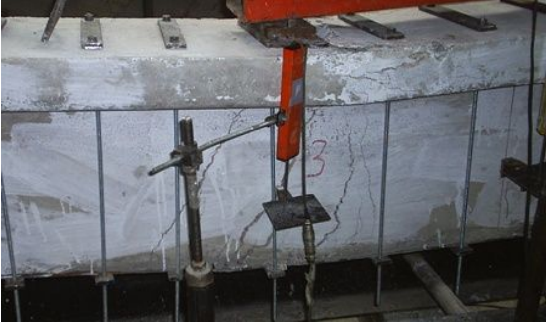
Resim 4.41.S10 deney elemanı levhanın koptuđu bölge
