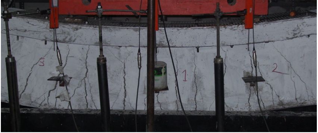
Resim 4.36. S8 deney elemanı hasarların yoğunlaştığı bölge
