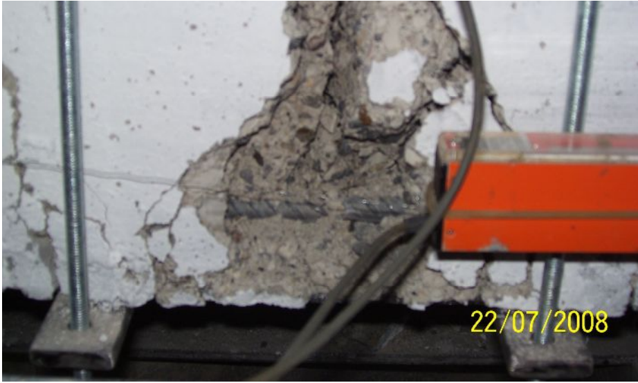
Resim 4.47.S12 deney elemanı kopan çekme donatısı
