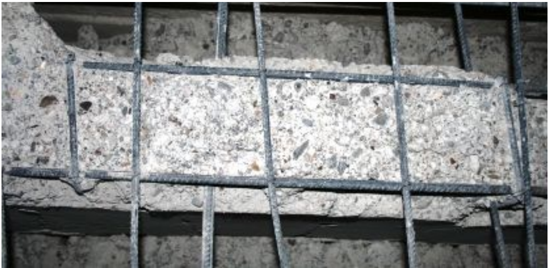
Resim 4.30. S5 deney elemanı ezilme bölgesi, molozlardan temizlenmiş
