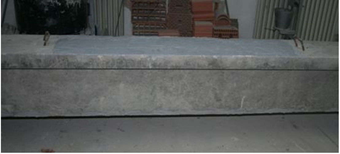
Resim 4.1. Resim 4.8. Basınç levhasını yapıştırmak için sürülen epoksi
