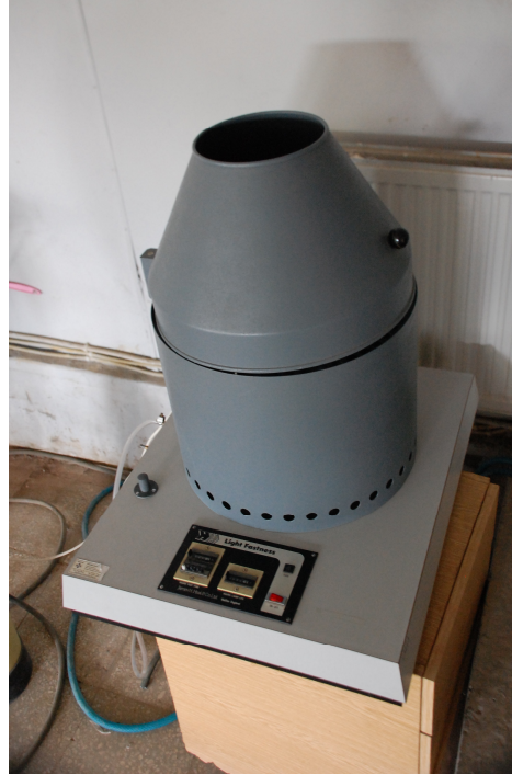
Şekil 3.4. Işık Haslık Cihazı: Light Fastness James H.Heal Co.Ltd. Halifax England
