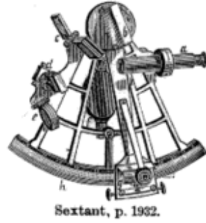
Şekil 3.14 Sekstant; Denizlerde gemicilerin, bulundukları yerin enlem ve boylamların belirlenmesi amacıyla, güneş ufuk düzlemi arasındaki açısal mesafeyi ölçen optik seyir cihazı
