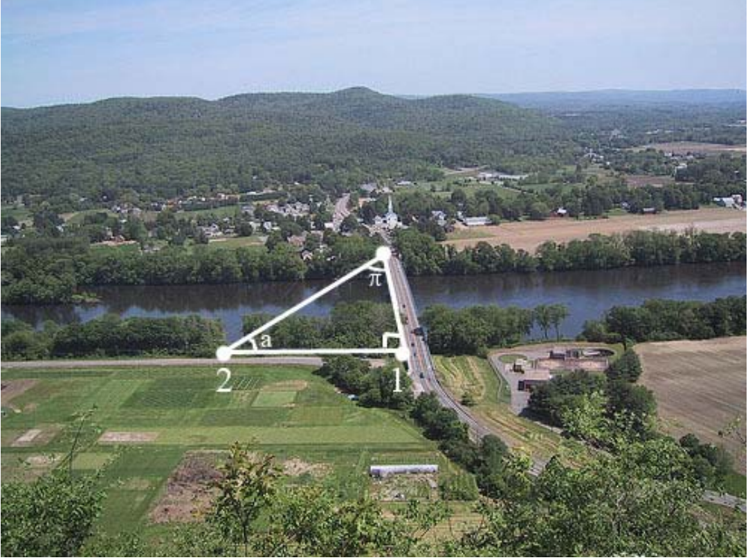
Şekil 3.91 Bir köprünün uzaklığının yanına gidilmeden ölçülmesi
