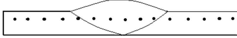
Şekil III.4. Vickers Sertlik Değerlerinin Alındığı Bölgeler
