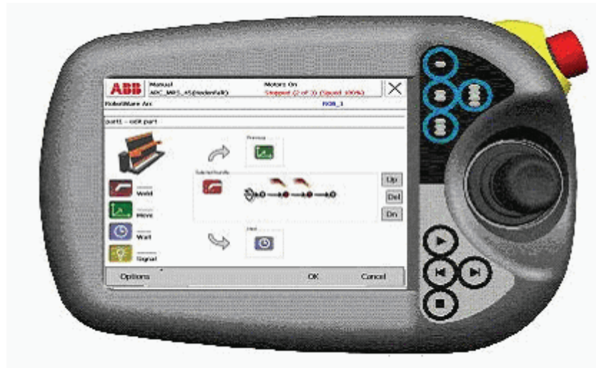
Şekil II.38 ABB Robotlarına Ait Robot Kolunun Hareketi İçin Kontrol Paneli [12].
