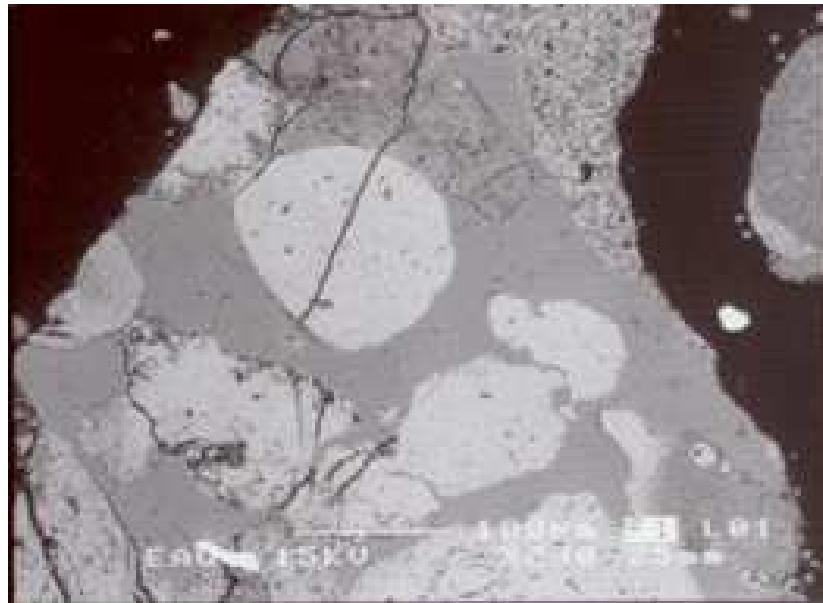
Şekil 3.3.b) Ham Fosfat Kayasının Bir Başka Yönden Taramalı Elektron Mikroskobu Görüntüsü
