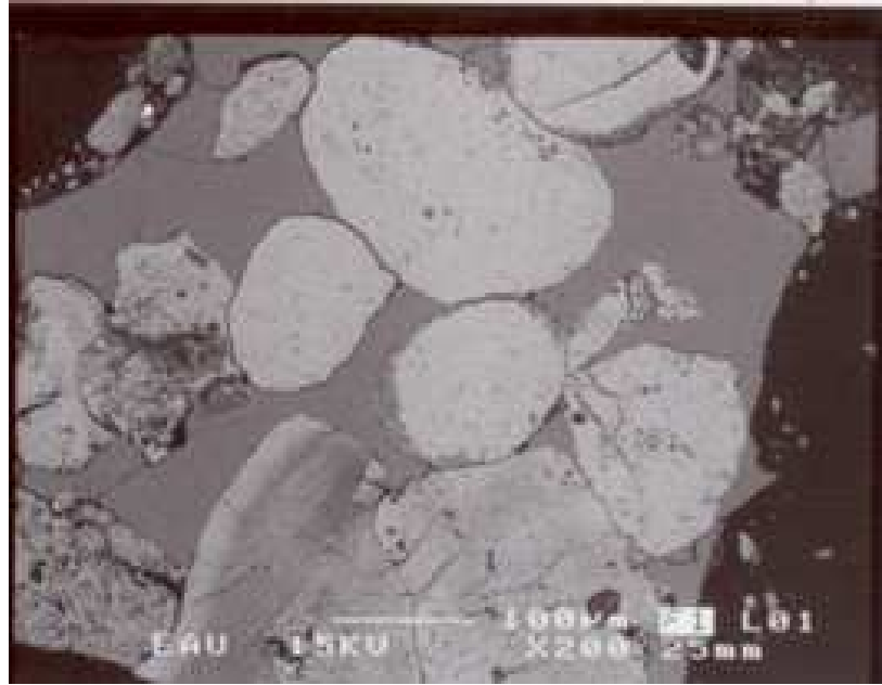
Şekil 3.3.a) Ham Fosfat Kayasının Taramalı Elektron Mikroskobu Görüntüsü
