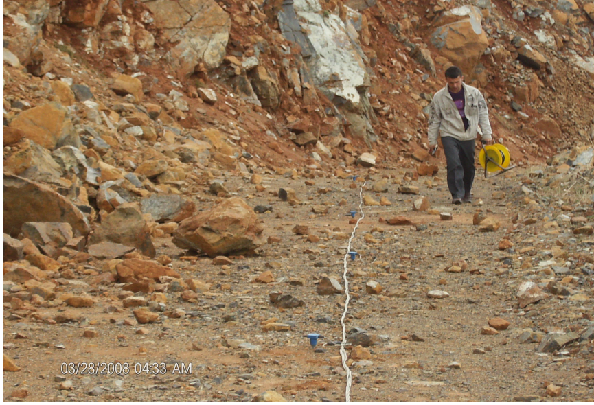
Şekil 6.20. Sismik yöntem ile Jeofonların profil boyunca dizilimi
