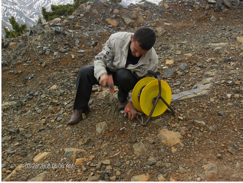
Şekil 6.4. Potansiyel elektrodunun yere çakılması ve bağlantının kurulması
