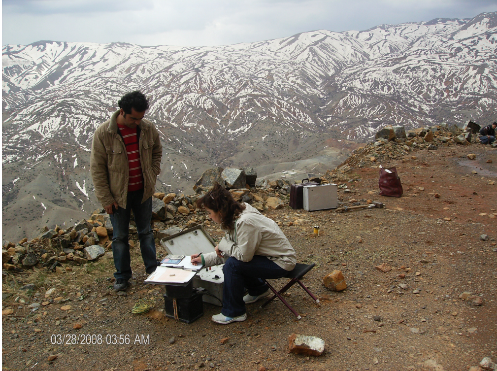
Şekil 6.5. İnceleme alanında rezistivite yöntemi. Alınan değerlerin ölçü karnesine hesaplanarak alınması.
