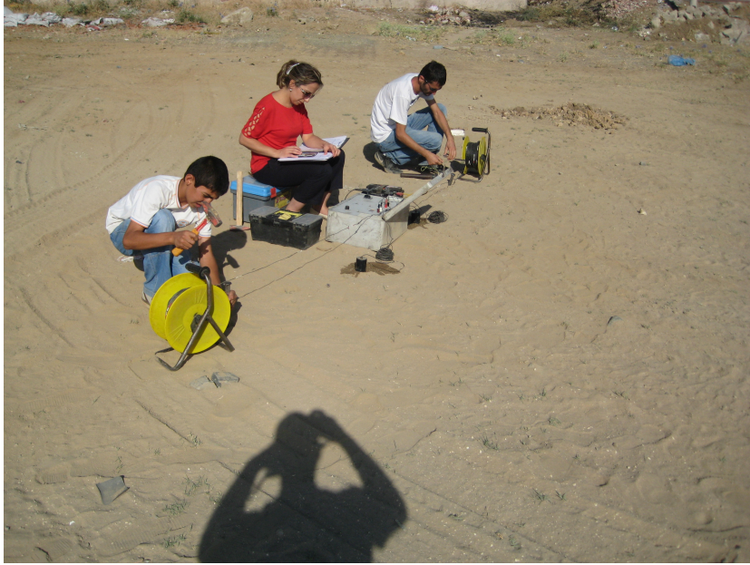
Şekil 5.4. Arazide Elektrot açılımı
