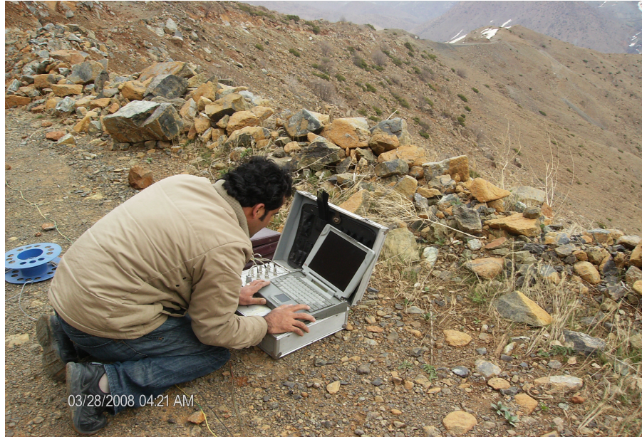
Şekil 6.21. Etüd alanında alınan ölçümün cihaza laptop aracılığıyla kaydedilmesi
