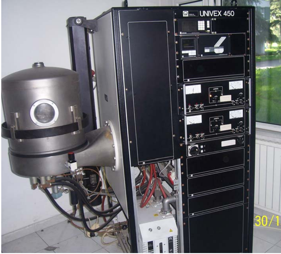
Şekil 5.1 Kaplama yapılan termal evaporatör
