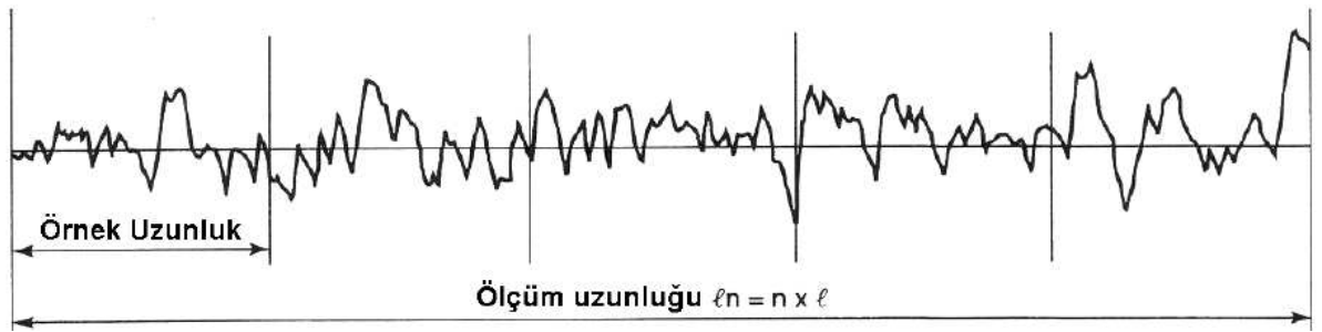
Şekil 4.2 Yüzey pürüzlülüğü ve değerlendirilmesi.
