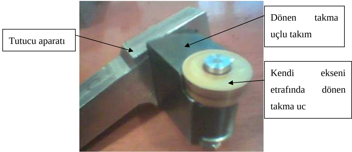
Şekil 6.11 Döner takma uçlu takım ve tutucu aparatının montaj hali.
