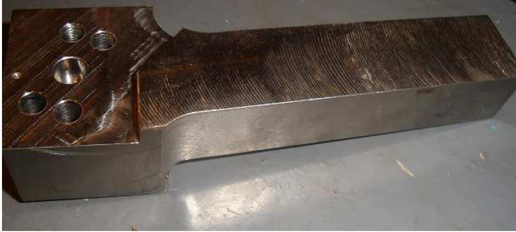
Şekil 6.7 5^\circ ve 45^\circ açılara sahip aparatın gerçek görüntüsü.
