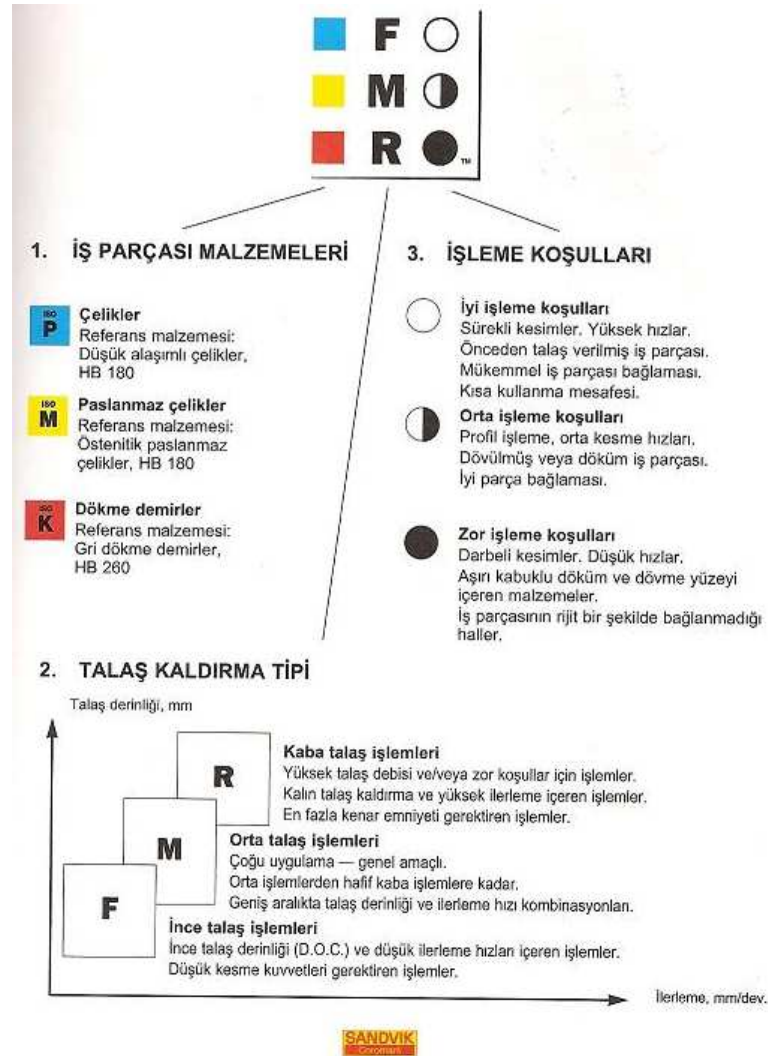
Şekil 2.1 Karbür uç kaliteleri ve uygulaması [10].
