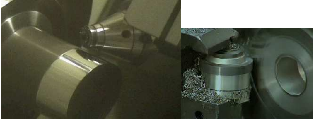
Şekil 3.8 Döner takma uçlu takımlarla sert tornalama işlemi [17].
