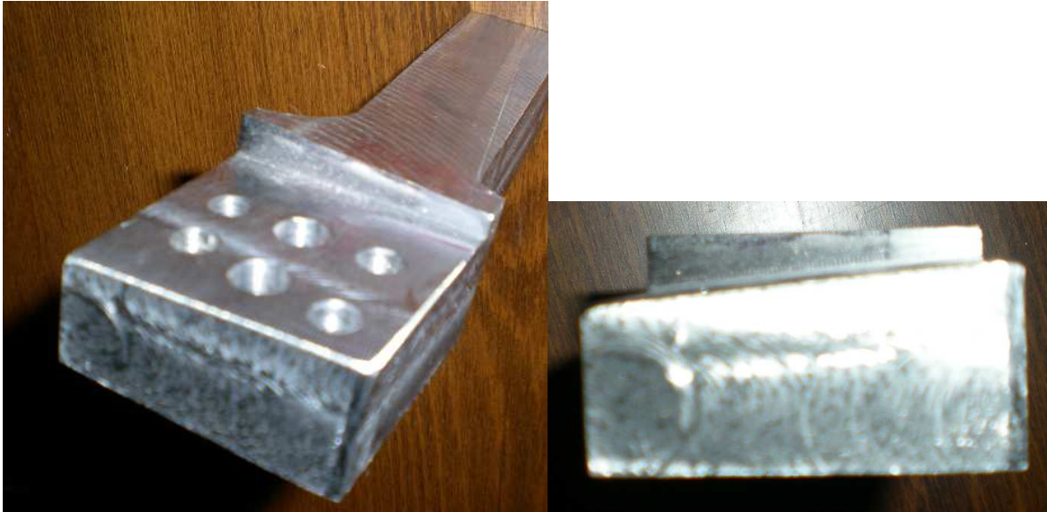
Şekil 6.12 -5^{\circ} talaş açısına sahip kendinden tahrikli döner takma uçlu takımın tutucu aparatı.
