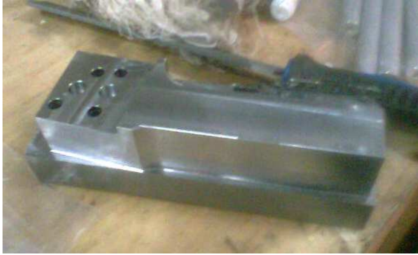
Şekil 6.9 10^0 ve 30^0 eğim açlarına sahip tutucunun işlemede ilk bağlama sonrasındaki görünüşü.
