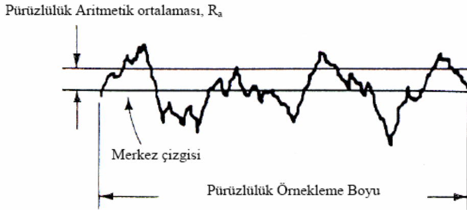
Şekil III.4 Yüzey Pürüzlülüğü Aritmetik Ortalaması
