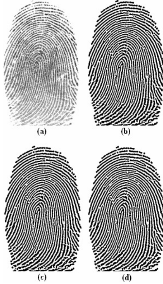
Şekil 3.19: Maskeleme İşlemleri Sonucunda Oluşan Parmak İzi Resimleri: (a) başlangıçtaki pekiştirilmemiş parmak izi, (b), (c), (d) gürültünün azaltılması için kullanılan maskelerden sonra sırasıyla elde edilen parmak izleri
