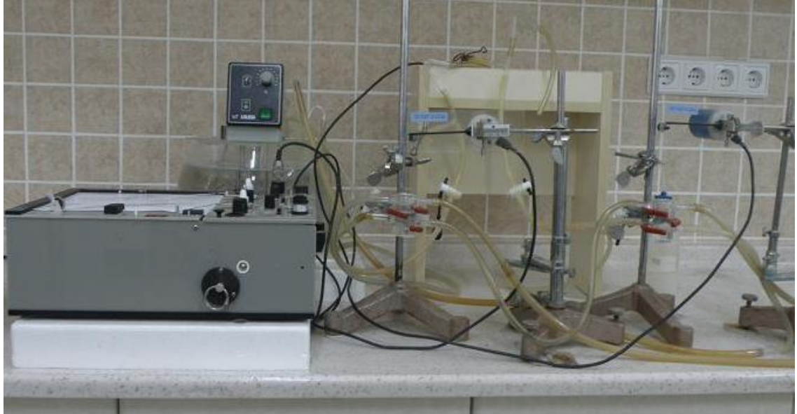
řekil 6: Organ banyosunda asılı dokularda kasılma alıřmalarının yapıldığı ve verilerin kaydedildiğı aygıtların görünümü
