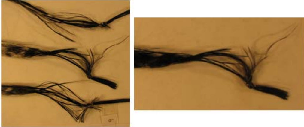
Şekil III.17. Kuru Karbon Elyaf Numunelerin Hatalı Kopma Şekilleri
