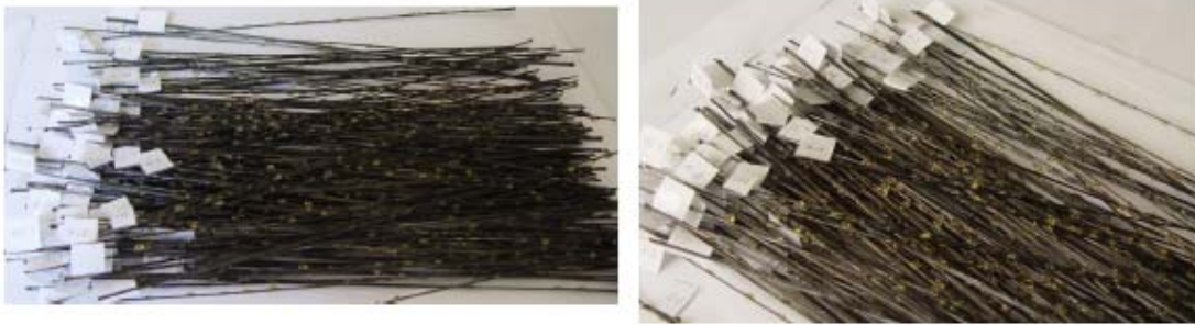
Şekil III.13. Kurutma İşlemi Sonucu Elde Edilen Reçine Emdirilmiş Karbon Elyaf Numuneleri
