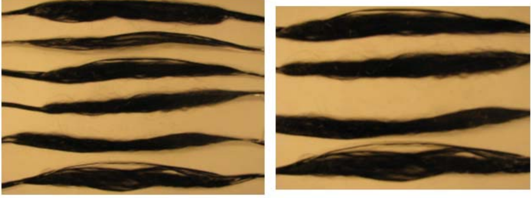
Şekil III.16. Çekme Deneyleri Sonucunda Kuru Karbon Elyaf Numunelerin Kopma Şekilleri
