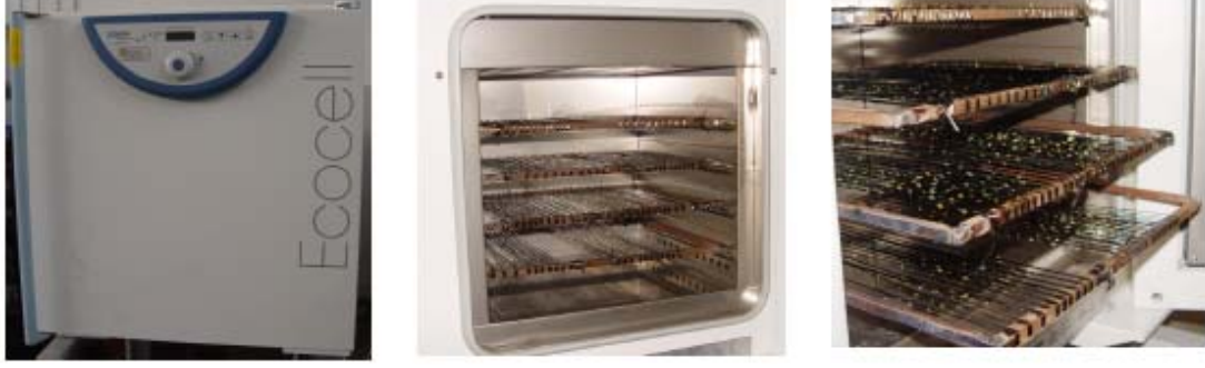
Şekil III.12. Ecocell Laboratuvar Kurutma Fırını Kullanılarak Karbon Elyafların Kurutma İşlemi
