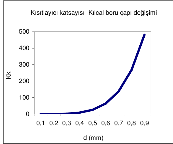
Şekil 2. 5. Kısıtlayıcı katsayısının kılcal boru çapına göre değişimi.
