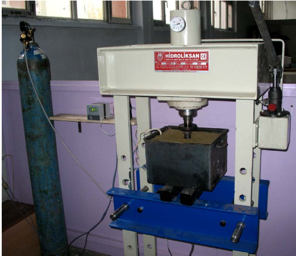
Şekil 3.3. Konvansiyonel sıcak presleme ünitesi ve hidrolik pres
