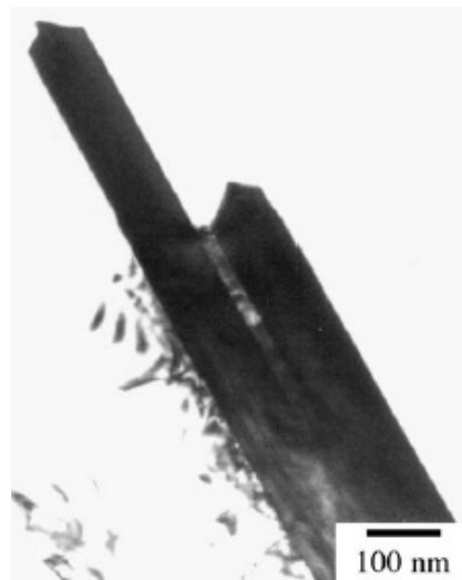
Şekil 1.5. Ti_3AlC_2 fazının TEM görüntüsü (Song et al. 2004)
