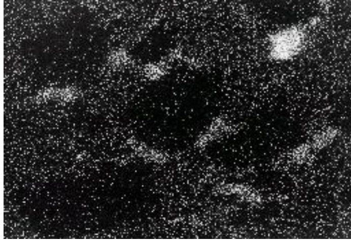
řekil 2.6. A356/20SiC kompozitin Mg EDS haritası: Mg elementi takviye fazı etrafında tercihli olarak yoęunlařmaktadır (Tekmen et al. 2003).
