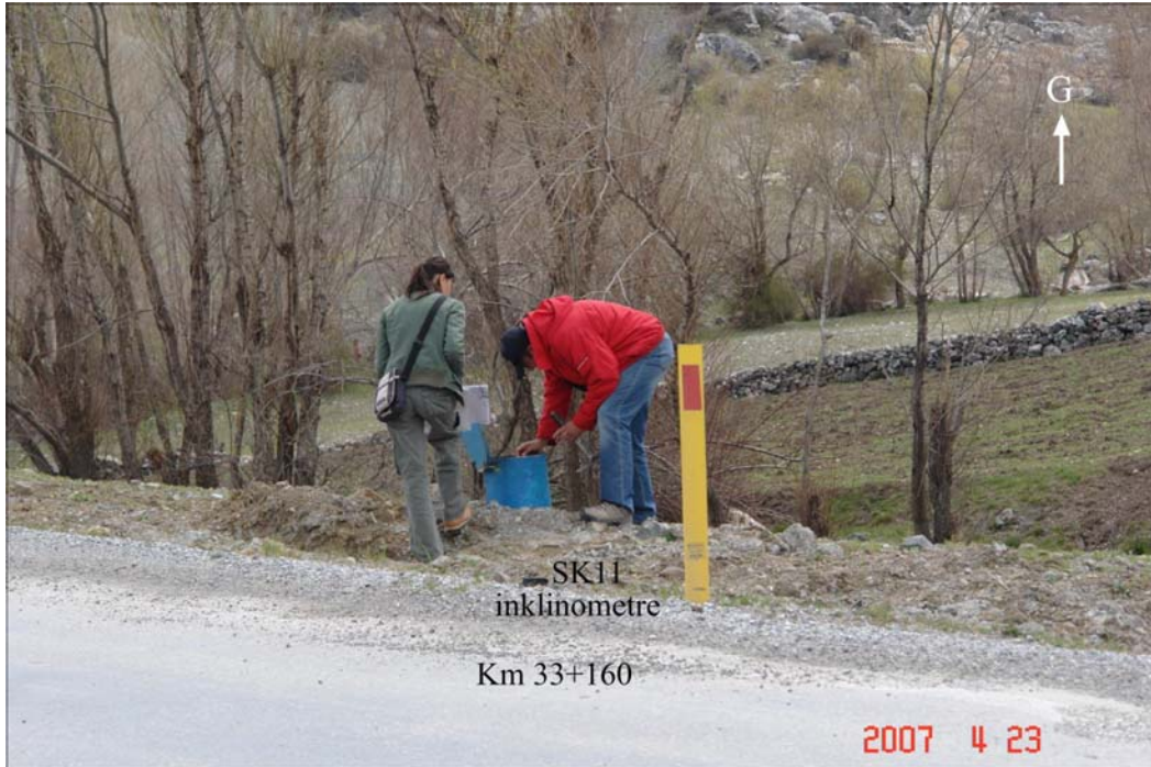
Şekil 3.1 Kaplankaya H1 heyelanı üzerindeki inklinometre ölçümü yapılan SK11 nolu sondaj kuyusu
